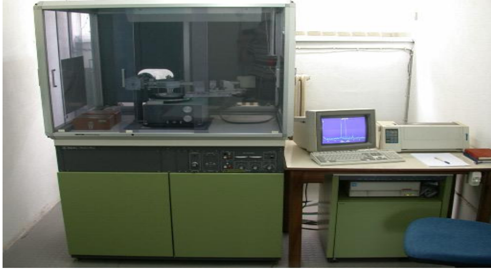
Şekil 9. Rigaku D/Max-III C marka X-ışını difraktometresi
