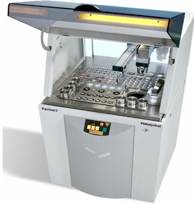
Şekil 10. Epsilon 5, PANalytical EDXRF cihazı
