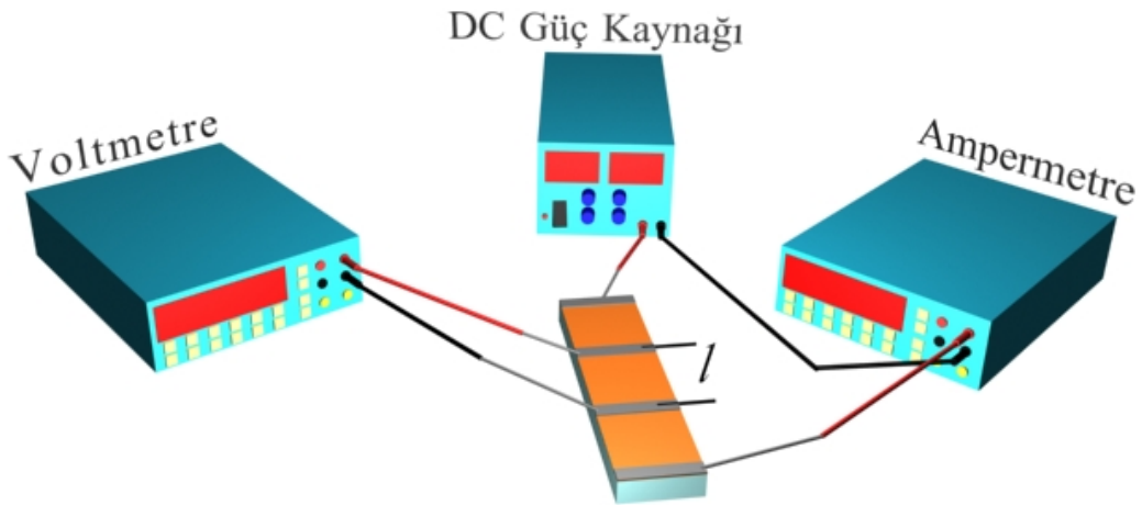
Şekil 22. Özdirenç ölçümü için kullanılan devrenin şematik gösterimi
