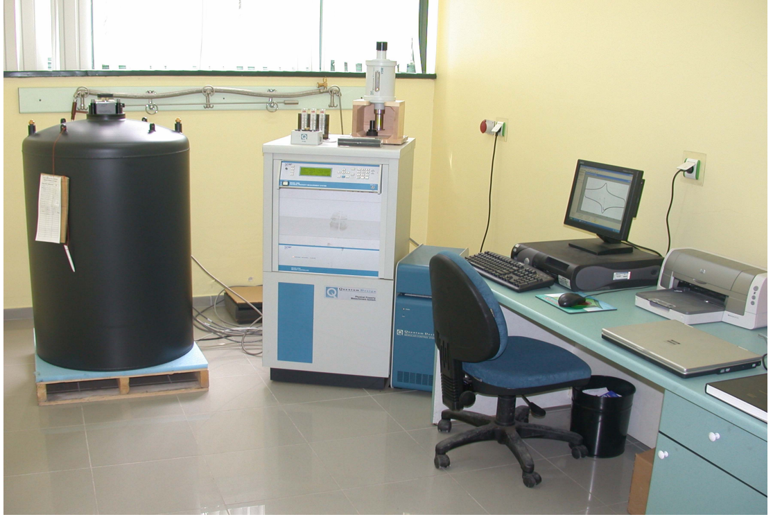
Şekil 2.9. Quantum Design PPMS sistemi
