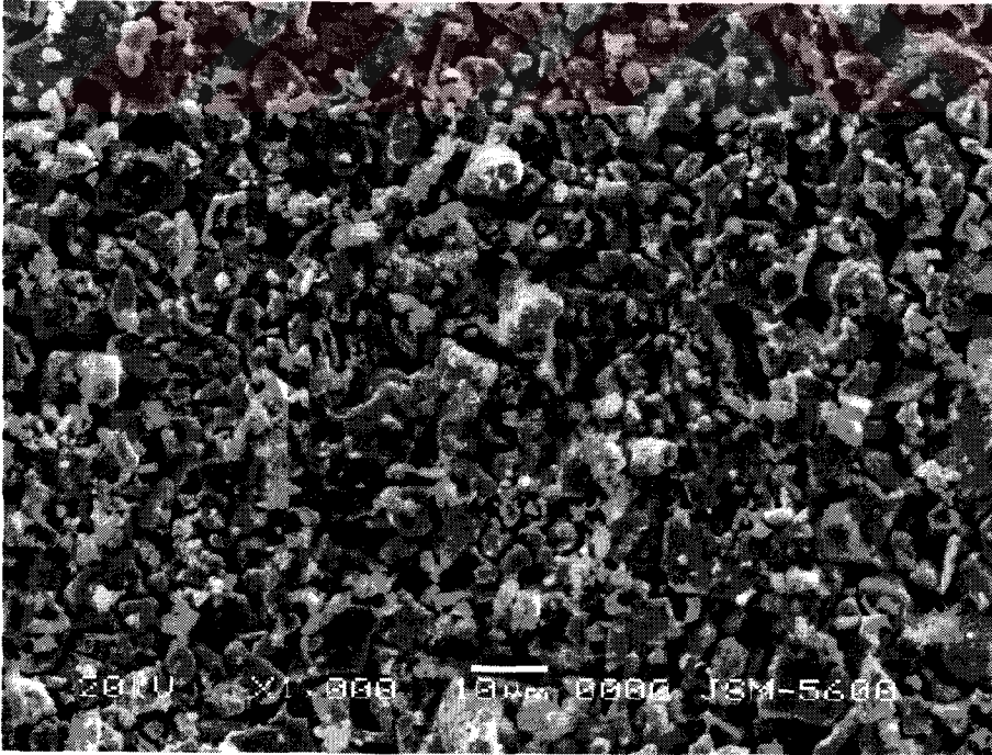
Şekil 42. Katıhal tepkime yöntemi ile üretilen YBa 2 Cu 2.7 Yb 0.3 O y numunesinin SEM fotoğrafı
