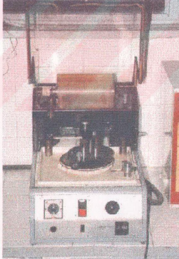
Şekil 40. Otomatik numune parlatma makinesi (Logitech PM2)
