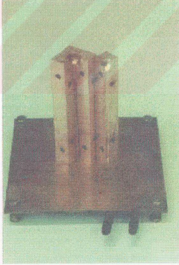
Şekil 34. Dört özdeş parçalı, 8 vidalı bakır kalıp
