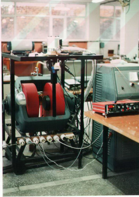
Şekil 21. Leybold-Heraeus HR1 model kapalı devre düşük sıcaklık kriyostati
