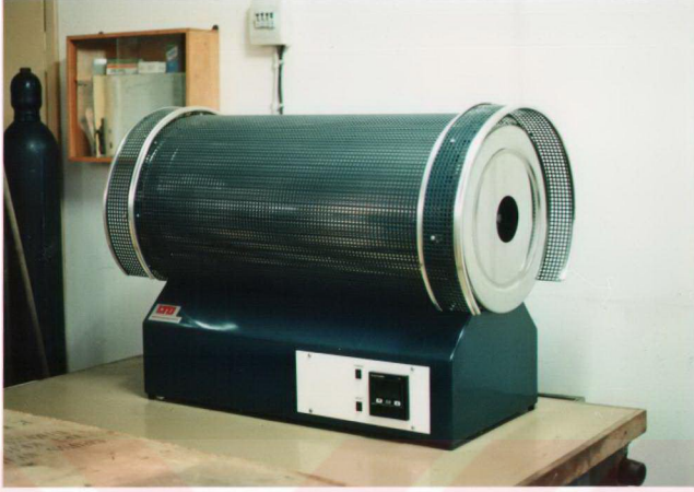
Şekil 13. Euroterm 818P kontrol ünitesi Lenton marka fırın
