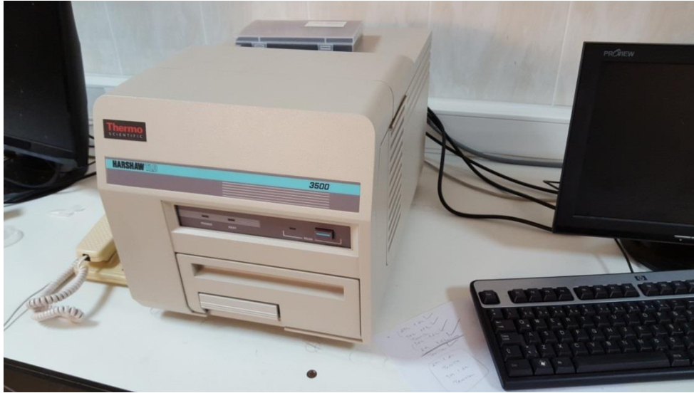
Şekil 3.6. Harshaw 3500 TL okuyucu.
