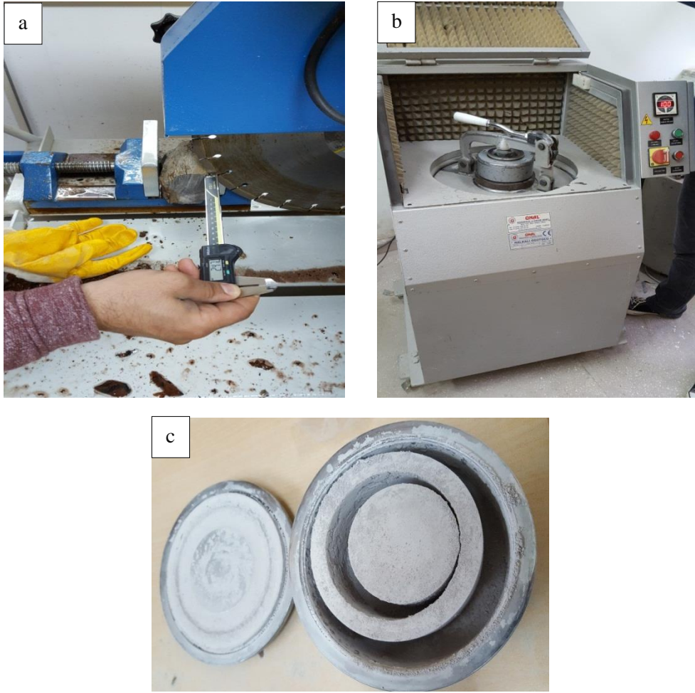
Şekil 3.11. Örnek elde edilmesinde kullanılan a) Taş kesme makinesi, b) Halkalı öğütücü, c) XRD analizi için toz örneğe ait fotoğraflar.
