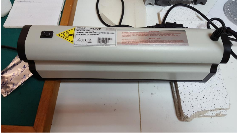
Şekil 3.9. Örnekleri ışınlamada UV ışık kaynağı olarak kullanılan UVP marka 3UV38 model ışık kaynağına ait fotoğraf.
