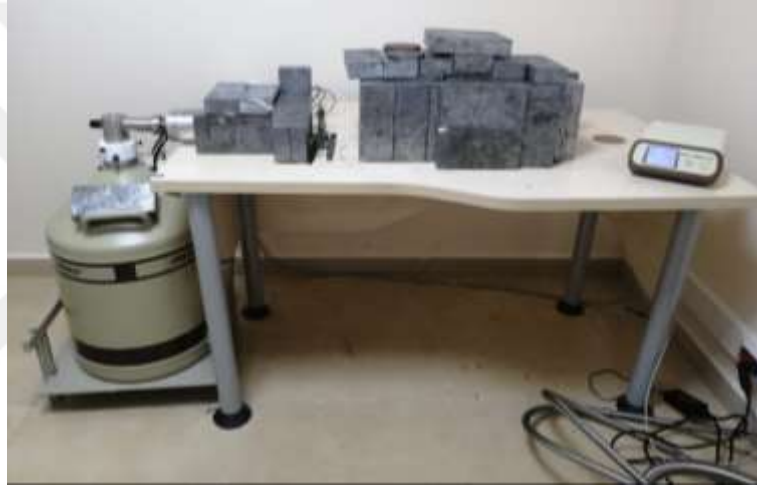
Şekil 2.2. ORTEC marka GEM-SP7025P4-B model HPGe gama detektörü
