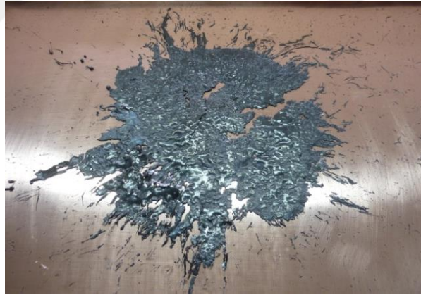
Şekil 2.4. Bakır bir plaka ile vurulmak suretiyle hızlı bir şekilde soğutulan YBCO
