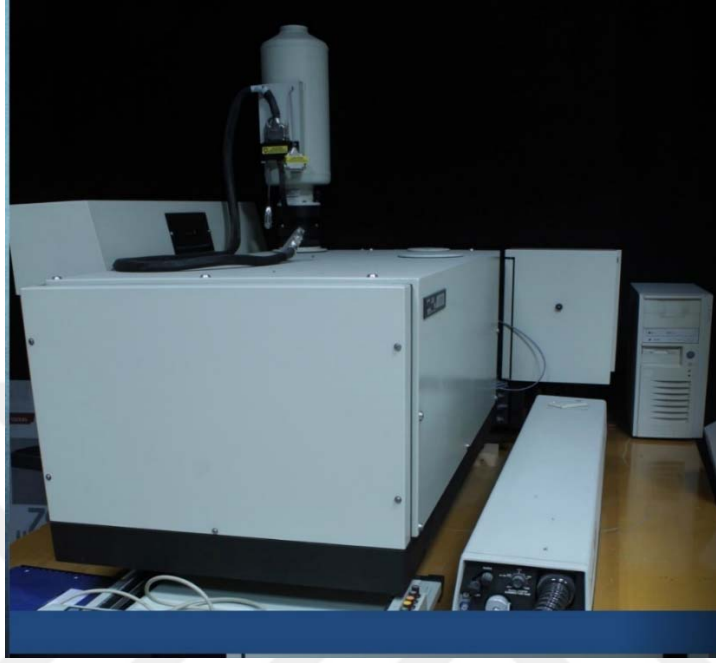
Şekil 2.6. Gazi Üniversitesi Fotonik Araştırma ve Uygulama Merkezi'nde bulunan Raman spektroskopisi cihazı.
