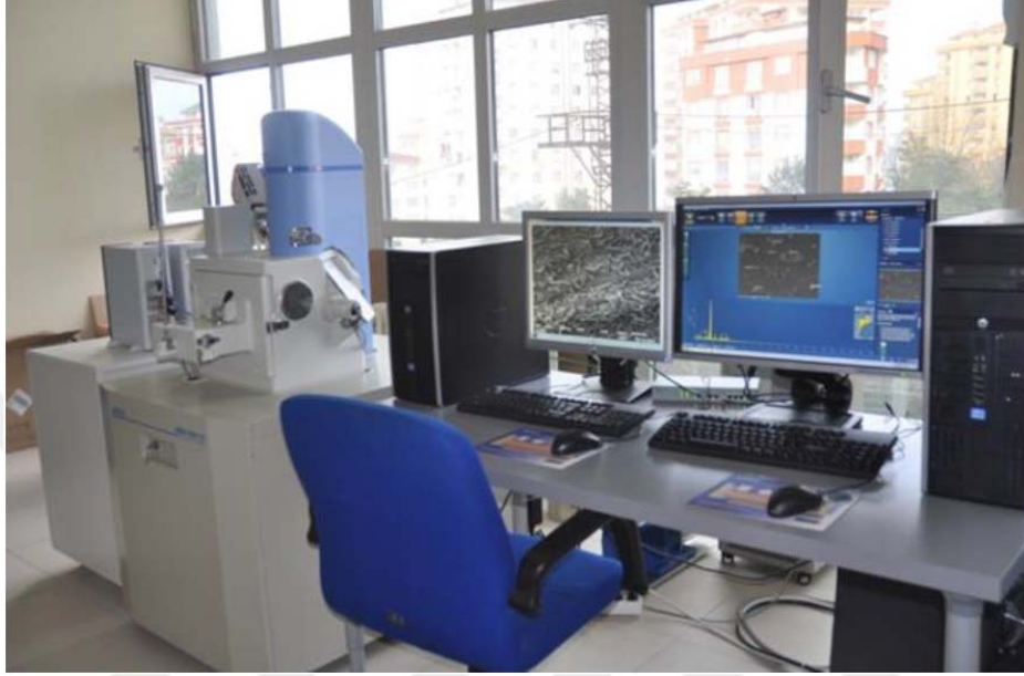
Şekil 2.8. JOEL JSM 6610 taramalı elektron mikroskobu ve SEM cihazına bağlı olan Inca X-act (Oxford Instruments) enerji dağılımı X-ışını spektrometresi (EDS) cihazları.
