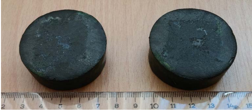
Şekil 2.3. \phi = 45\text{mm} çap ve h = 15\text{mm} yüksekliğe sahip silindir şeklinde külçe YBCO süperiletkenleri
