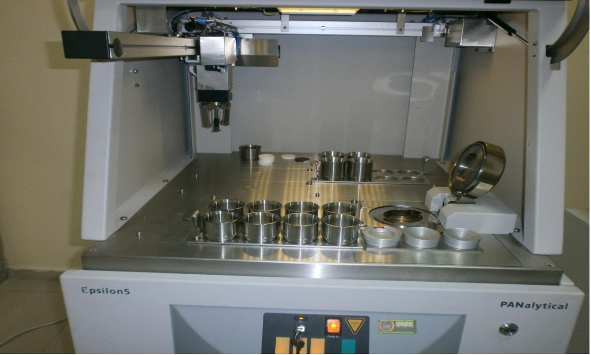
Şekil 2.3. Epsilon5, PANalytical cihazının numune haznesi
