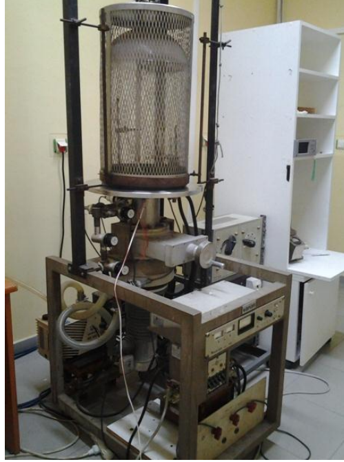
Şekil 2-2. Varian 840 vakum buharlaştırma sistemi
