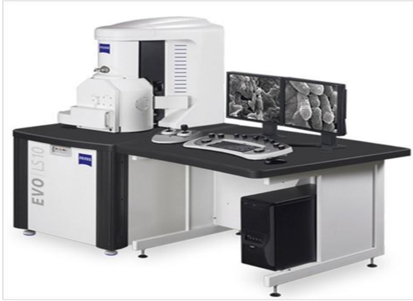
Şekil 2-5. Taramalı elektron mikroskobu (ZEISS EVO LS15)
