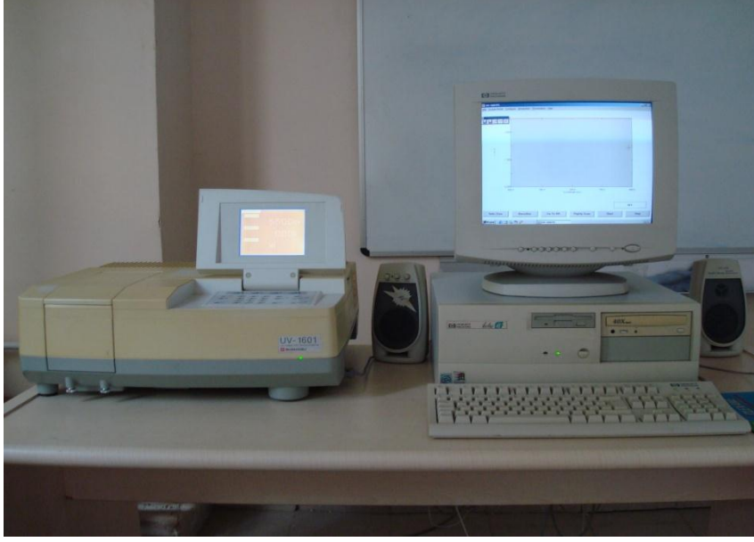
Şekil 2-6. UV-Visible spektrofotometresi (Shimadzu UV-1601)
