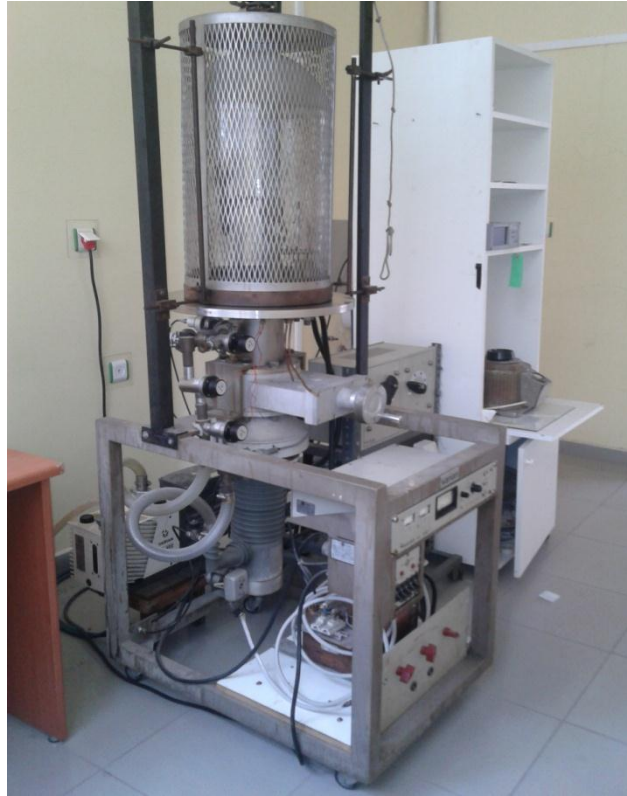
Şekil 2-2. Varian NRC 840 vakum sistemi
