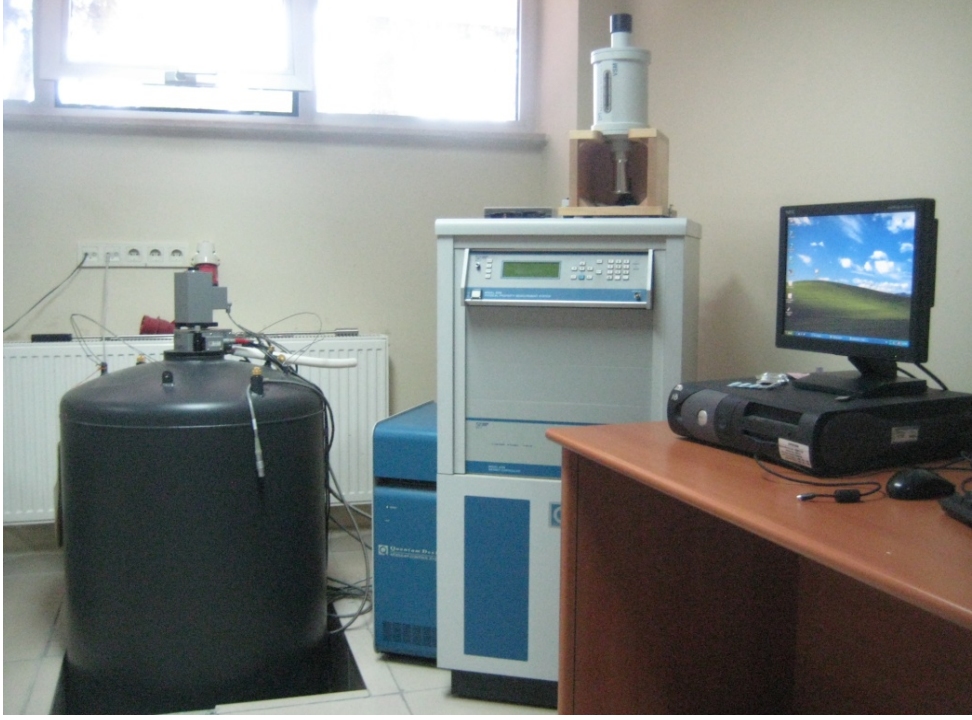
Şekil 2.5. Quantum Design PPMS (Fiziksel Özellik Ölçüm Sistemi)
