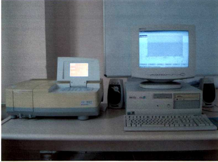
Şekil 14. UV-Visible spektrofotometresi (Shimadzu UV-1601)
