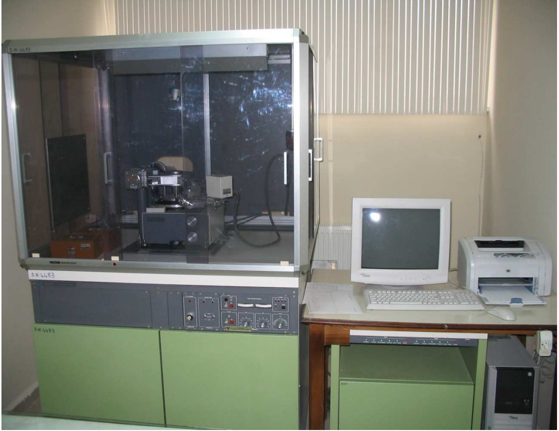
Şekil 15. X-ışını difraktometresi (Rigaku D/Max-IIIC)
