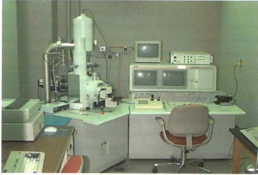
Şekil 16. Taramalı elektron mikroskobu (JEOL JST-6400)
