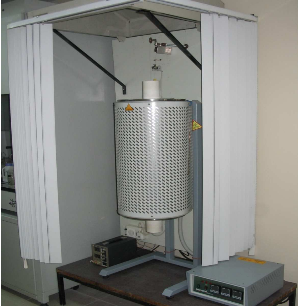
Şekil 12. Üç bölge dikey fırın (Protherm)
