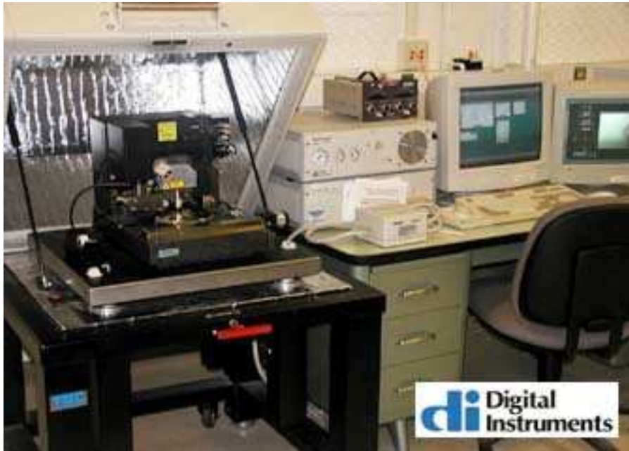
Şekil 17. Atomik kuvvet mikroskobu (Digital Instruments Dimension 3100)
