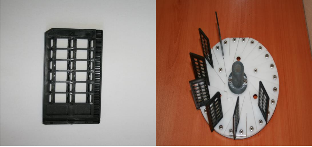
Şekil 10. Radoslayt dedektör tutucu (soldaki) ve kazıma diski (sağdaki) (ÇNAEM laboratuvarı)
