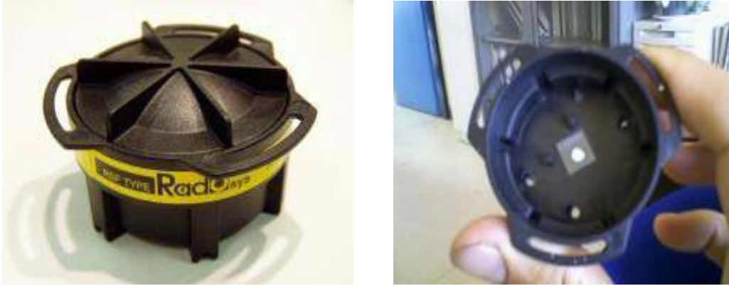
Şekil 14. CR-39 Dedektörü ve iç kısmı
