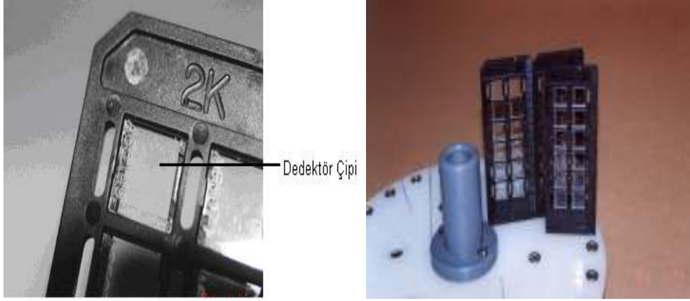
Şekil 15. Dedektör çipi ve kazıma diski
