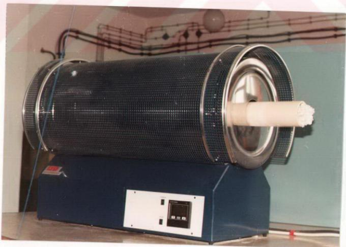
**Şekil 16.** Euroterm kontrollü Lenton marka tüp fırın
