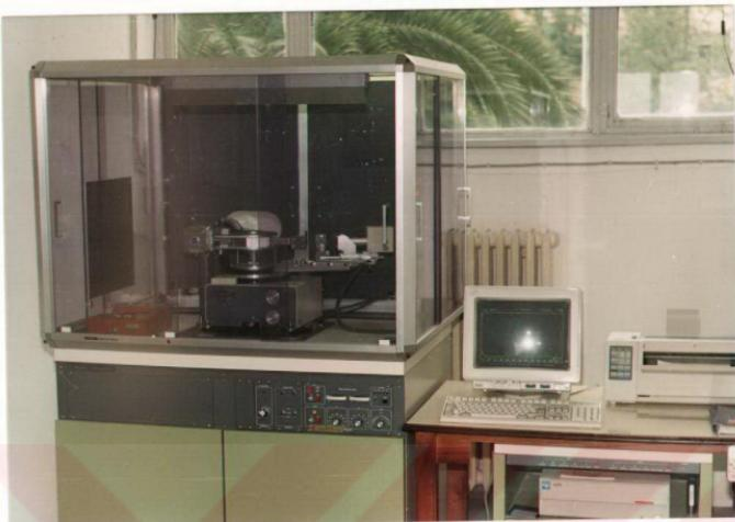
**Şekil 19.** Rikagu D/Max III C difraktometresi
