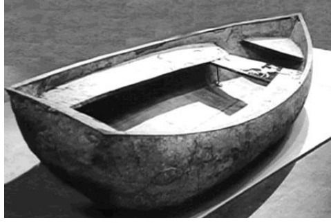
Şekil 1.1. Joseph Louis Lambot'un betonarme tekniğini kullanarak yapmış olduğu tekne (URL-1, 2018)
