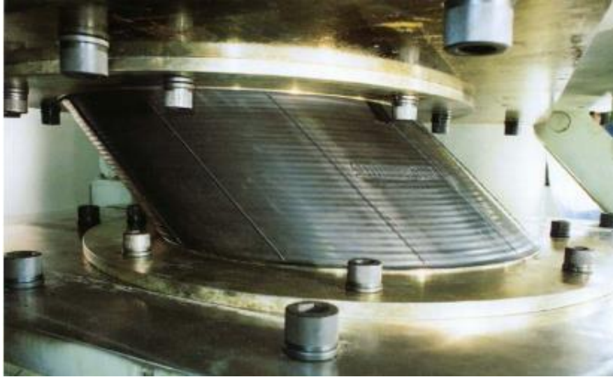
Şekil 1.10. Katmanlı kauçuk mesnette şekil değişimleri
