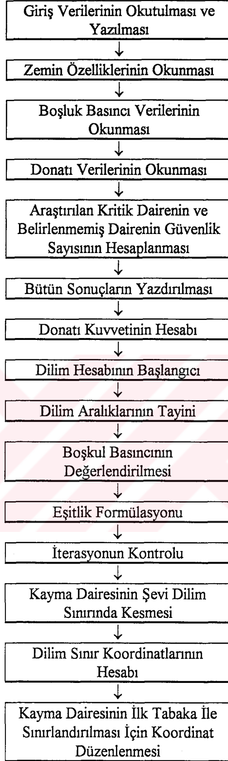
Şekil 38. Şev stabilite analizlerinin İsveç dilim ve değiştirilmiş Bishop metodu ile hesabının akış mantığı
