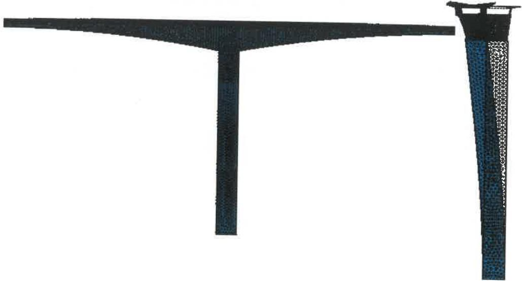
Şekil 2.50. Spektrum analizi sonucunda elde edilen deformasyon şekli
