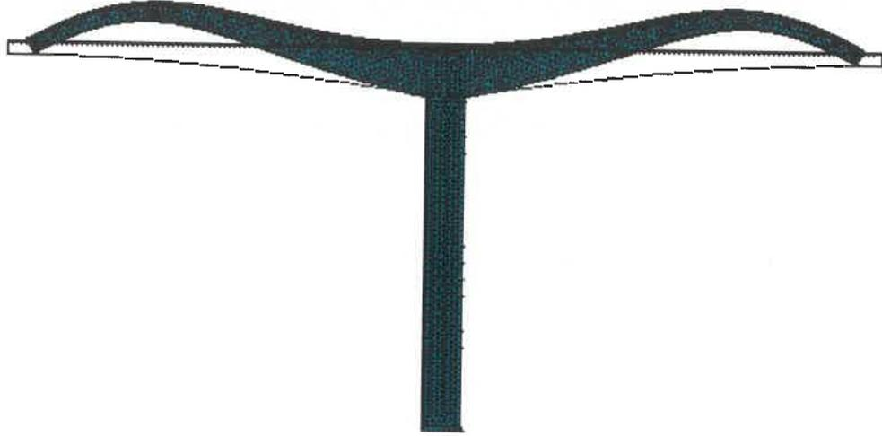
Şekil 2.33. Ardgerme kuvveti altında köprünün deformasyon şekli
