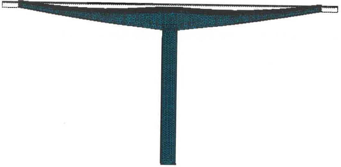
Şekil 2.41. Kendi ağırlığı ve taşıt yükü altında köprünün deformasyon şekli
