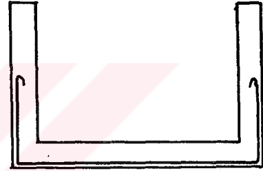
Şekil 4.6. Taban Donatısının Duvara Uzatılması.
