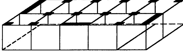
Şekil 24. Bir betonarme perde-çerçeve sistem
