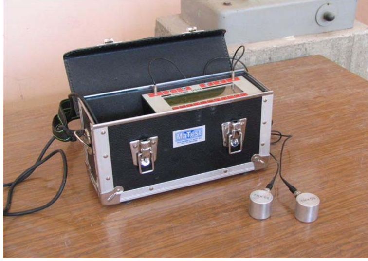
Şekil 1. MaTest marka ultrases dalga hızı makinesi
