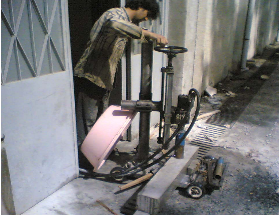
Şekil 7. Prizmatik numunelerden karot alma işlemi
