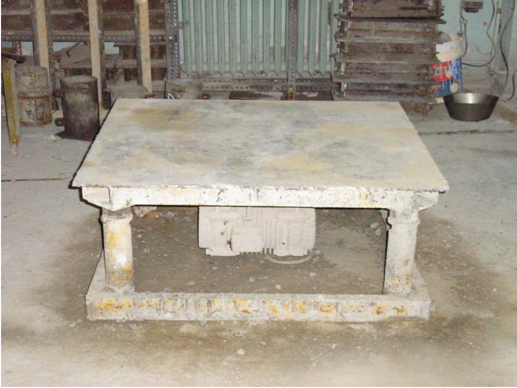
Şekil 5. 2800 devir/dakikalı sarsma tablası
