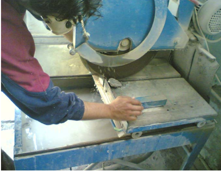
Şekil 8. Karotların kesilme işlemi
