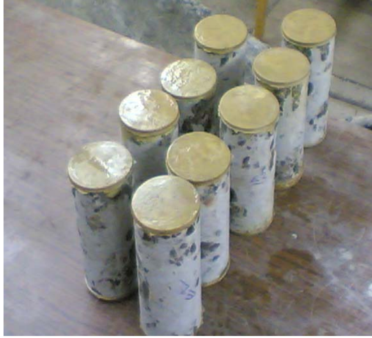
Şekil 10. Deneye hazır hale getirilmiş 75 mm çaplı karotlar
