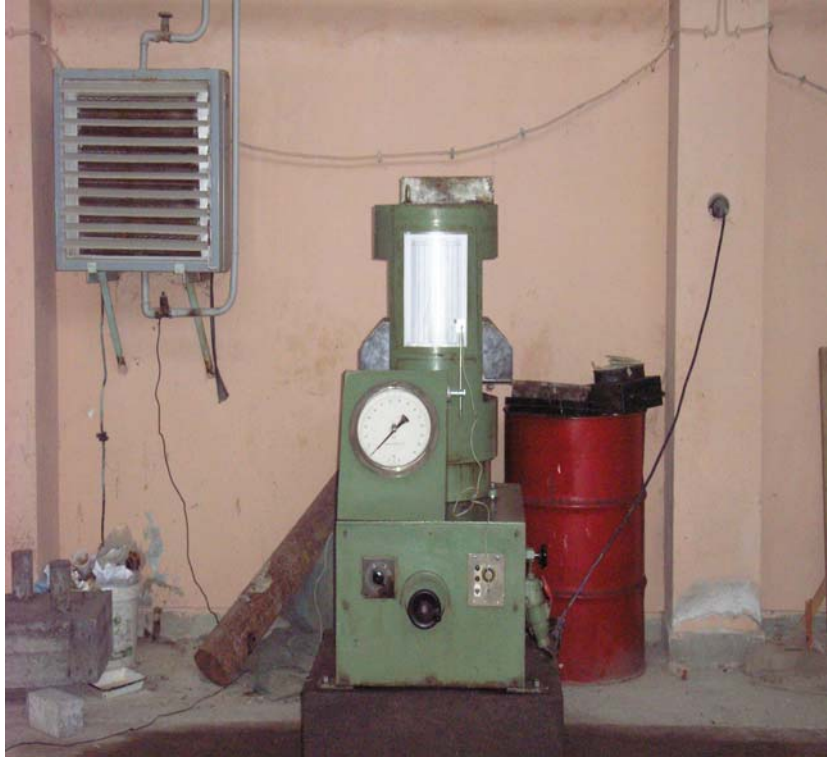
Şekil 11. 300 tonluk WP 300 tipi merkezi basınç aleti
