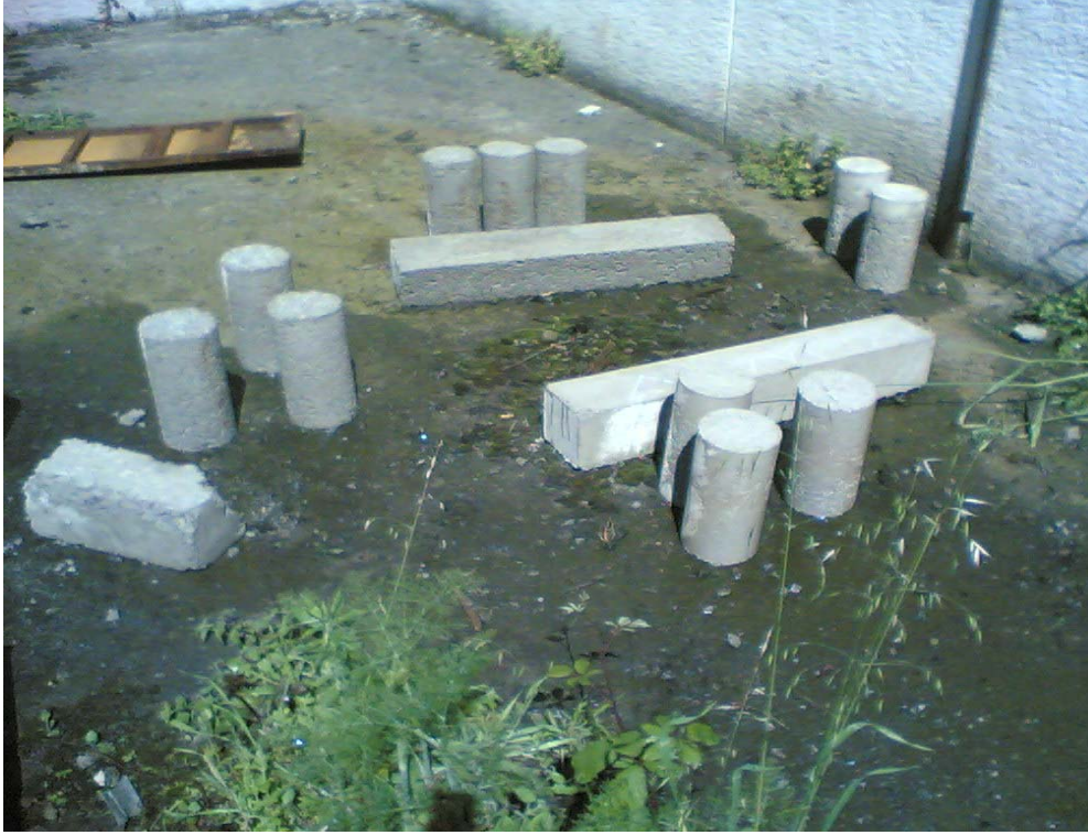
Şekil 6. Dış kür ortamında saklanan standart silindir ve prizmatik numuneler
