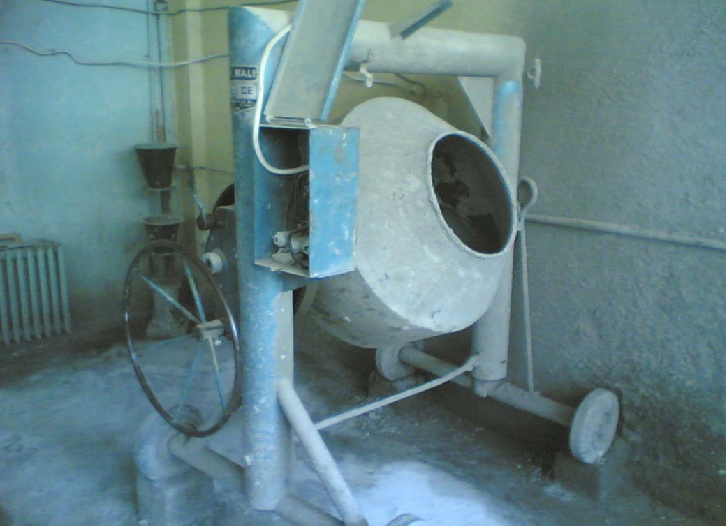
Şekil 4. 80 litre kapasiteli eğik eksenli betoniyer
