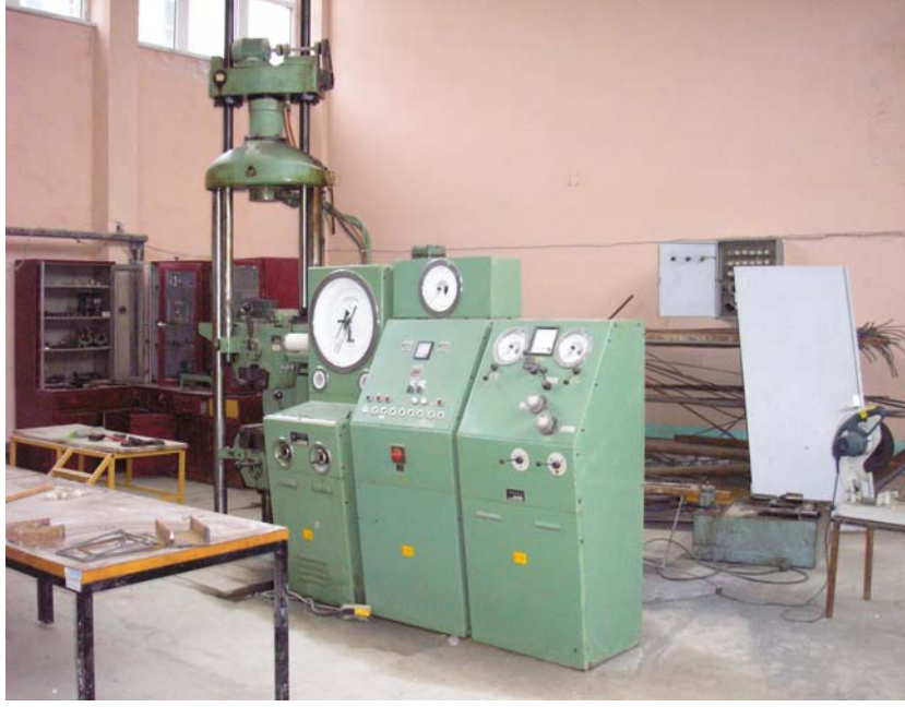
Şekil 12. 60 tonluk Losenhausenwerk marka UHP 60 tipi universal deney aleti
