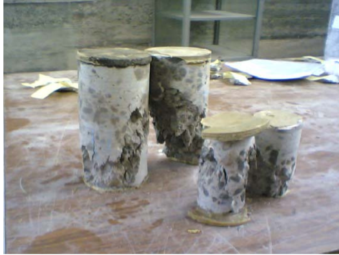
Şekil 13. Merkezi basınç deneyi uygulanmış karot numuneler.
