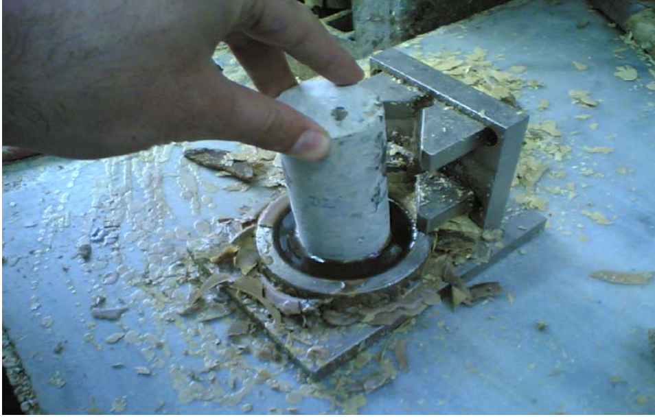
Şekil 9. Karotların erimiş kükürtle başlıklanması
