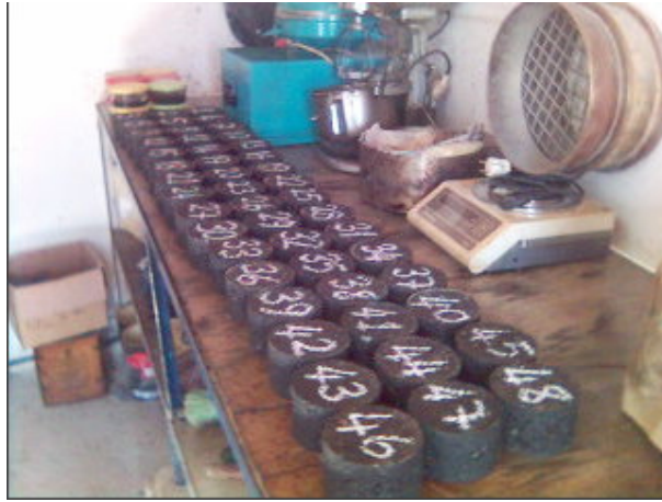
Şekil 19. Çalışmada Kullanılan Asfalt Karışım Briketleri
