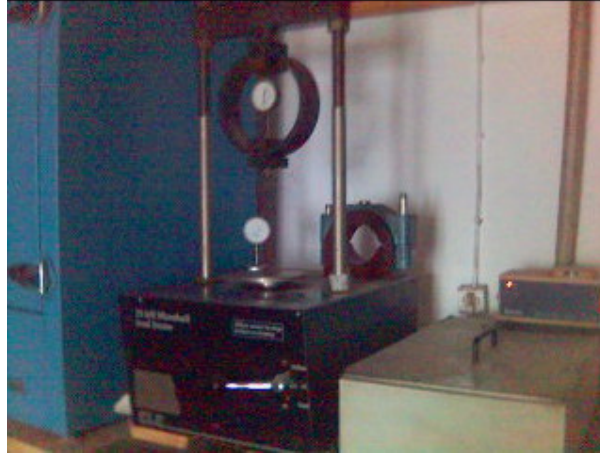
Şekil 21. Stabilite ve akma deęerlerinin ölçüldüğü cihaz (Marshall Load Frame, ELE)
