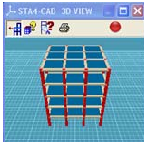
Şekil 3.11. Uygulamaya konu olan binanın STA4’de üç boyutlu modellenmesi
