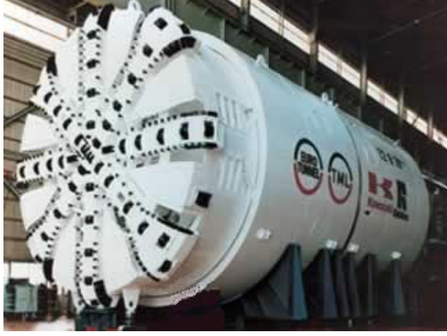
Şekil 1.17. Tam kesitte tünel açma aygıtından bir görünüm
