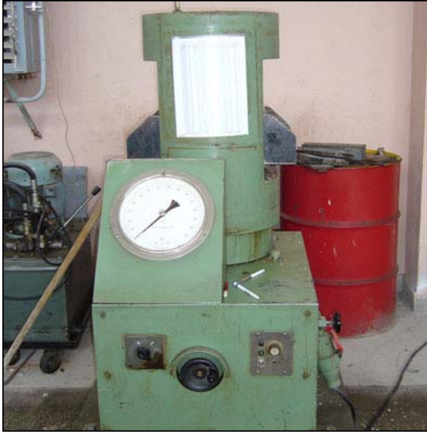
Şekil 44. 3000 kN'luk WP 300 tipi merkezi basınç aleti
