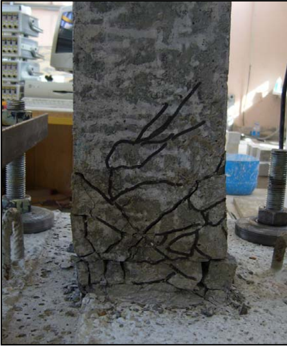
Şekil 46. Yüksek performanslı betonarme kolonlara ait kırılma şekilleri
