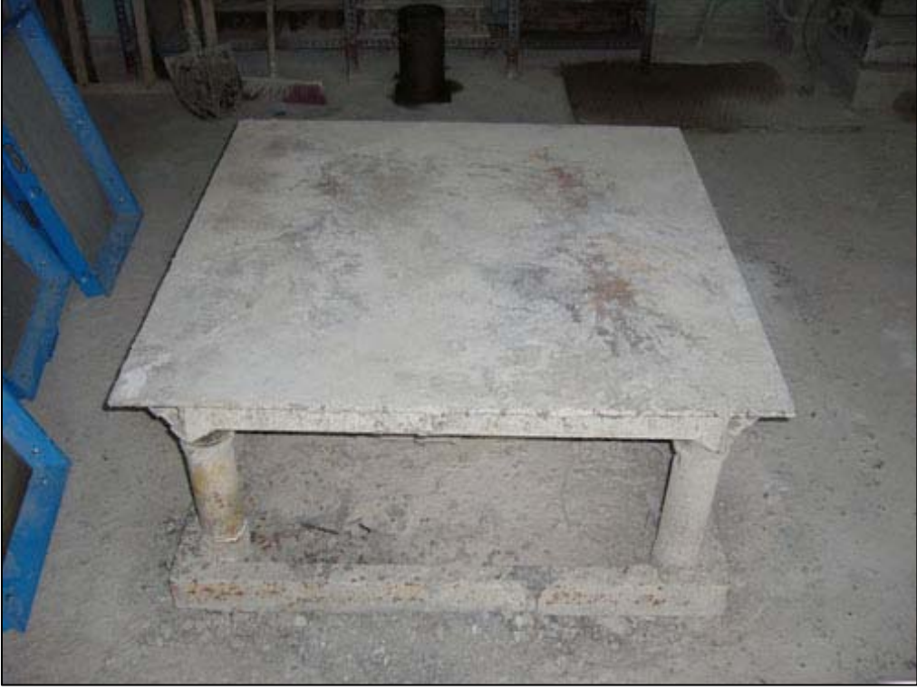
Şekil 31. Deneyde kullanılan 2800 devir/dakika frekanslı sarsma tablası
