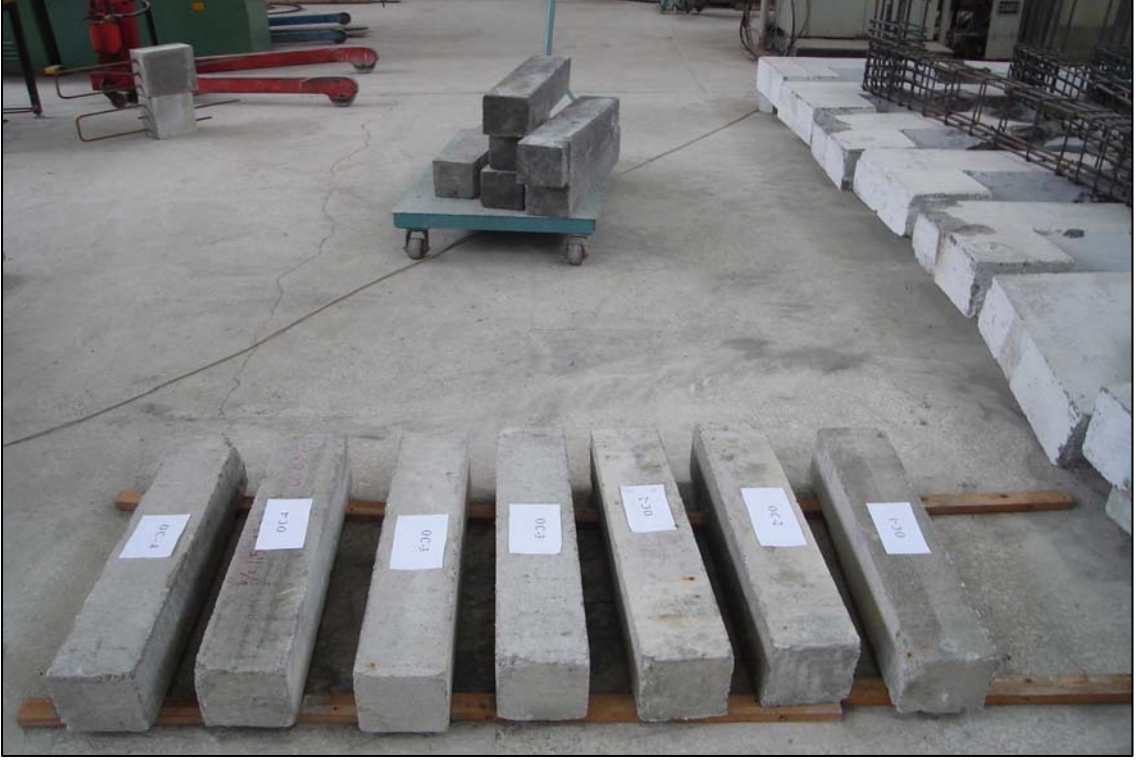
Şekil 34. Yapılan deneylerde kullanılmak üzere üretilen betonarme kolonlar
