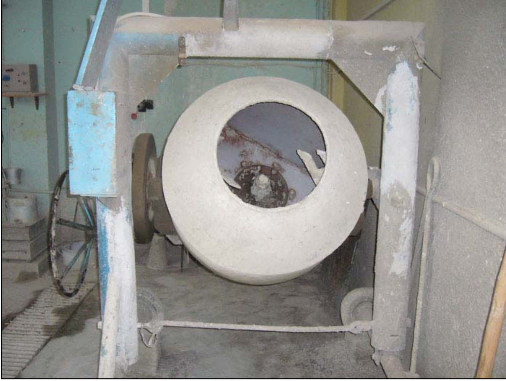
Şekil 30. Betonların üretiminde kullanılan 80 dm 3 kapasiteli eğik eksenli betonyer
