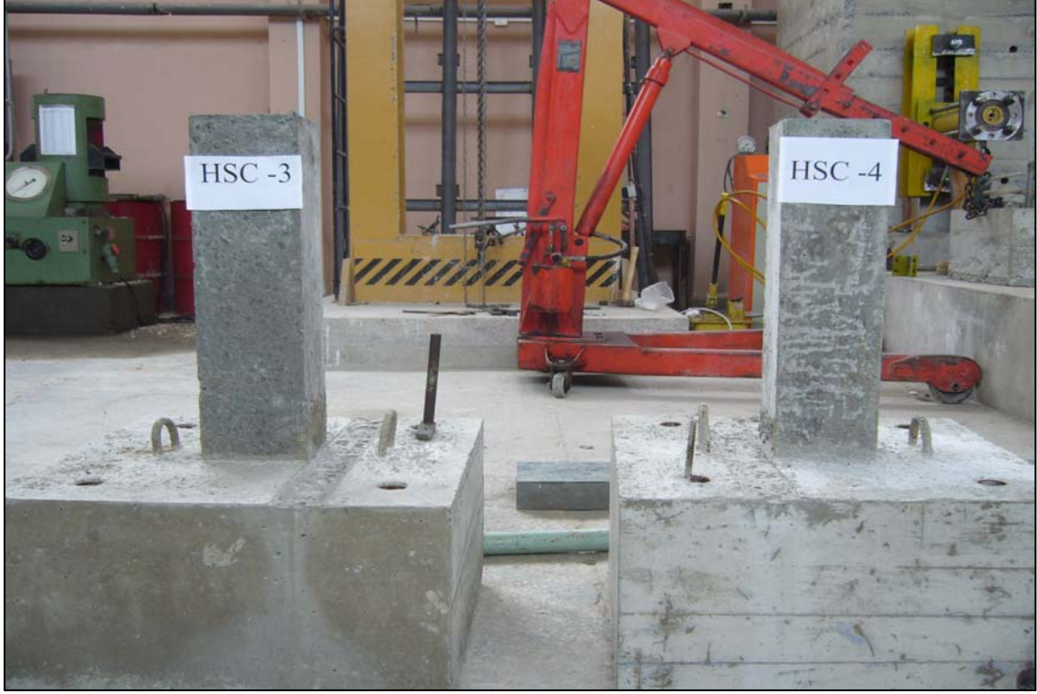
Şekil 38. Üretilen kolon temel sistemleri
