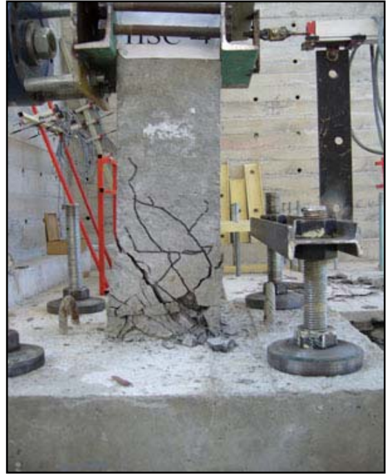
Şekil 46. Yüksek performanslı betonarme kolonlara ait kırılma şekilleri
