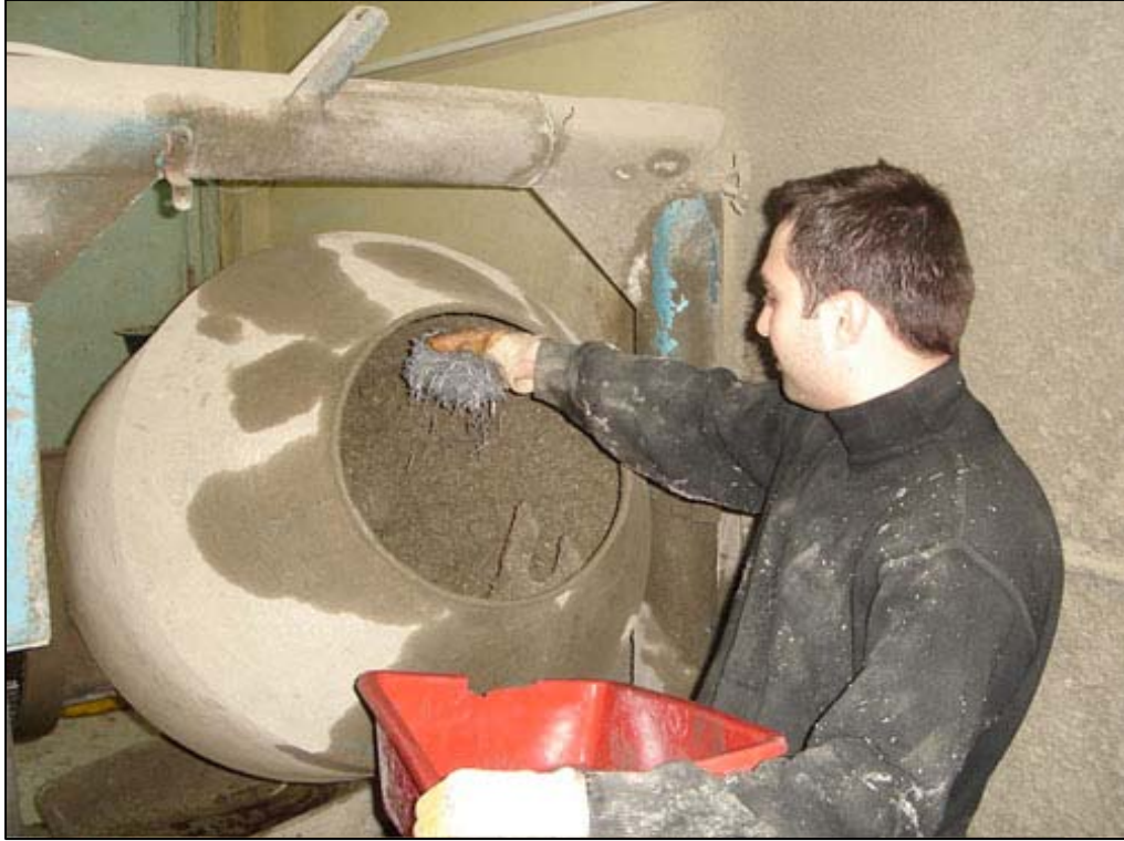
Şekil 33. Çelik liflerin betona ilave edilişi
