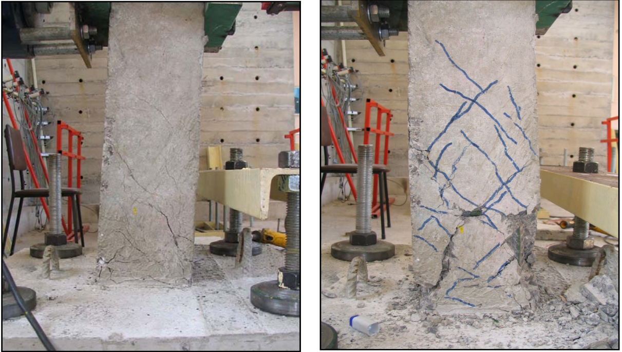
Şekil 45. Geleneksel betonarme kolonlara ait kırılma şekilleri
