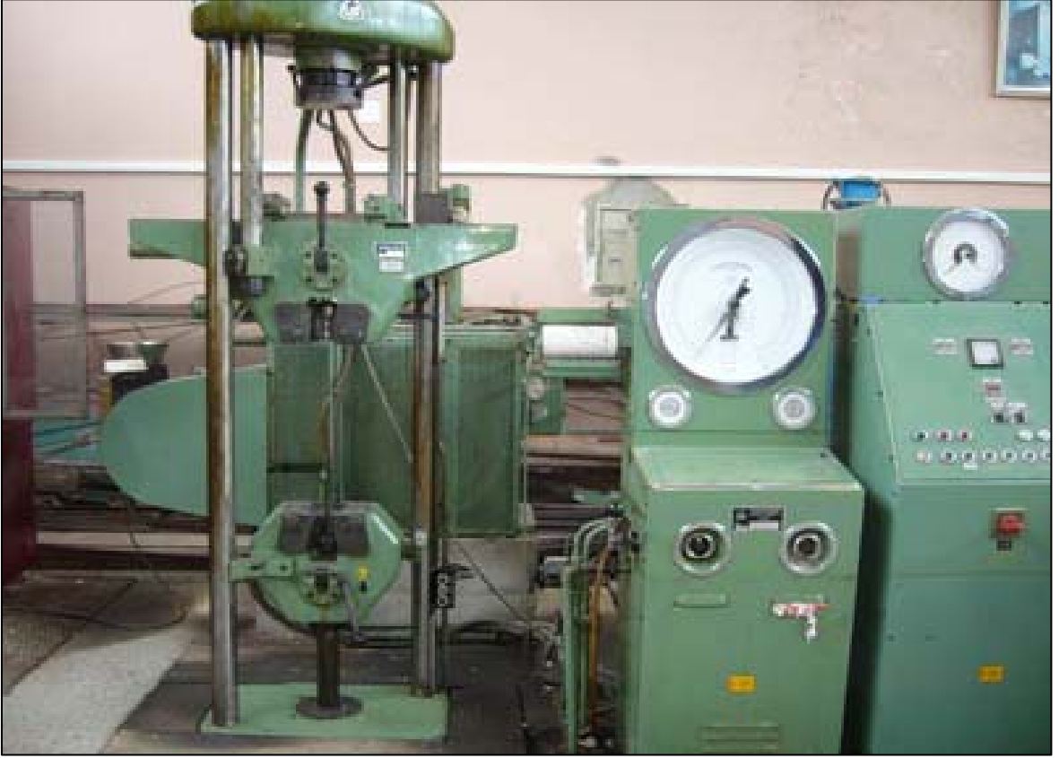
Şekil 26. 600 kN kapasiteli losenhaukwerk marka UHP 60 tipi üniversal deney aleti
