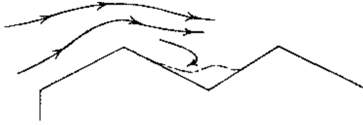
Şekil 7. Çatı derelerinde karın yığılması
