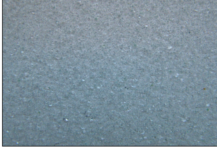
Şekil 28. Cam küreciği serpilmiş, zımparalanmamış boya
