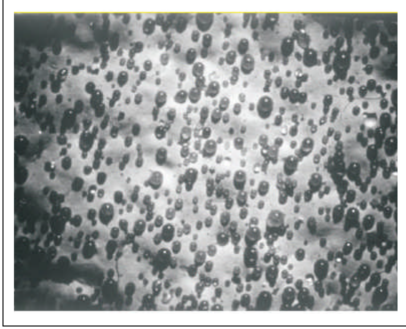
Şekil 14. Boyama sırasında çok geç atılan cam küreciği [14]
