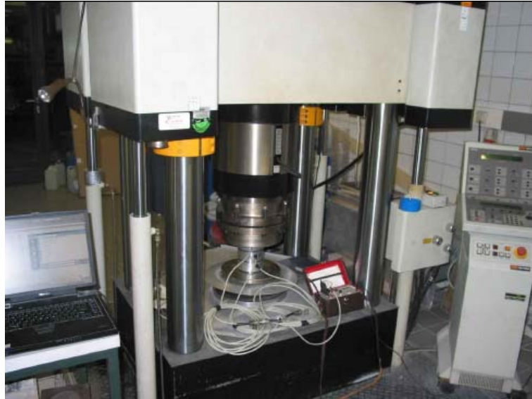
Şekil 41. Karot numunelerinin basınç mukavemetinin ölçümü
