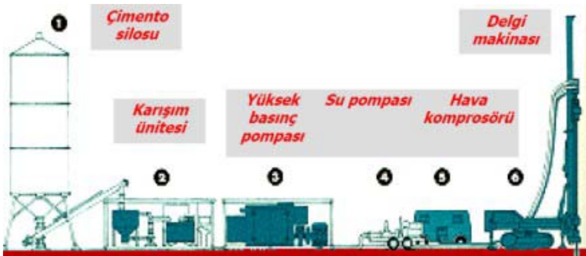
Şekil 22. İdeal jet enjeksiyonu tesisi
