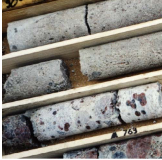
Şekil 40. Jet enjeksiyon kolonlarından alınan karot örnekleri
