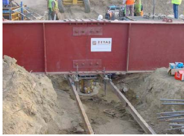
řekil 44. Basınç ve yükleme deneyi uygulaması
