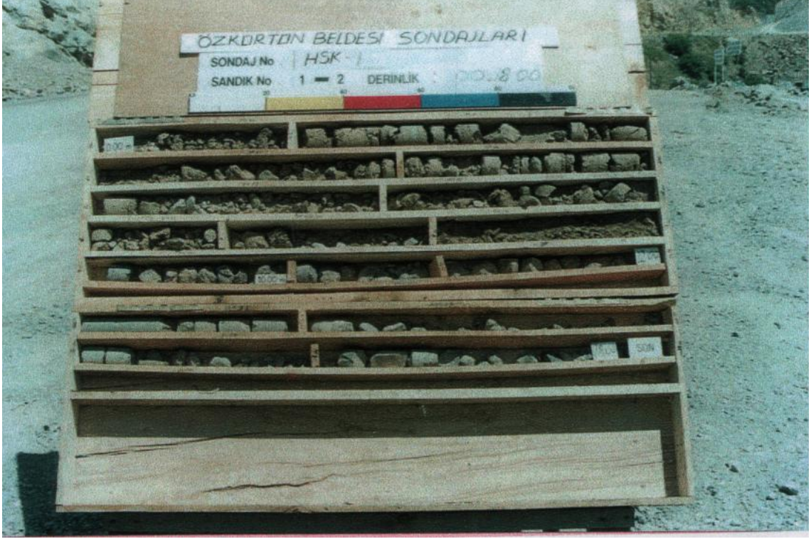
Ek Tablo 3. HSK-1 nolu sondaj kuyu karot fotođrafı
