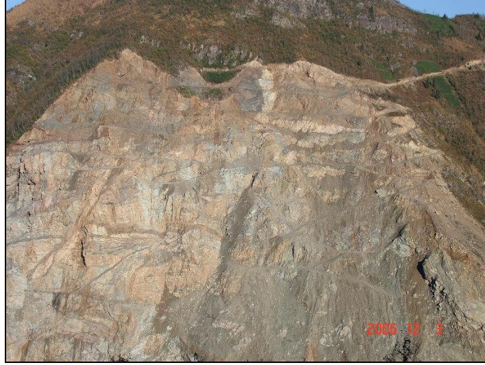
Şekil 22. Köprüküy taşocağında basamak patlatmasının uygulandığı kademeler
