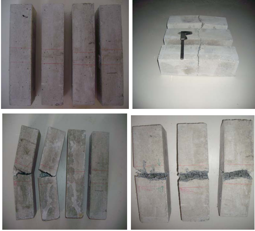
Şekil 2.35. Eğilmede çekme deneyine tabi tutulmuş çelik lifli beton numuneler
