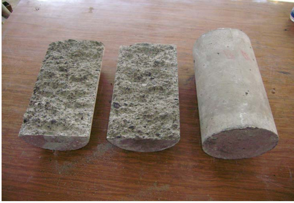
Şekil 2.25. Yarmada çekme deneyine tabi tutulmuş lifsiz beton numuneler
