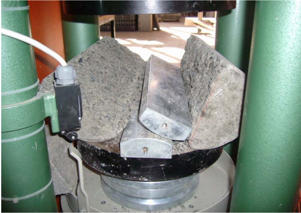
Şekil 2.23. Yarmada çekme dayanım deneyinde lifsiz beton numune kırılma şekli
