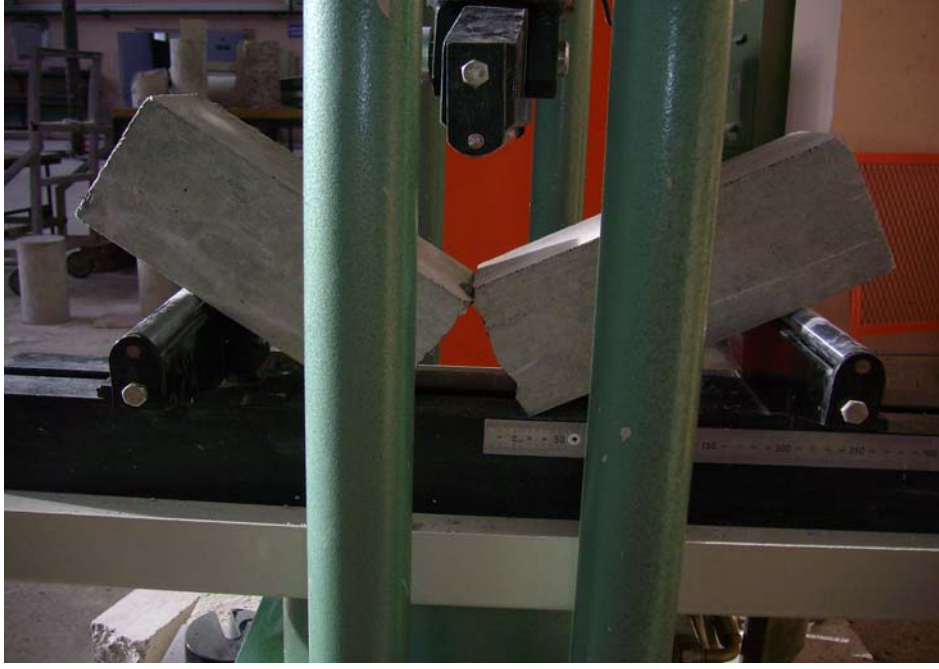
Şekil 2.33. Eğilmede çekme deneyinde lifsiz beton numunesinin kırılma şekli
