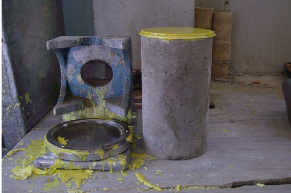
Şekil 2.8. Beton numunesinin başlıklama işlemi
