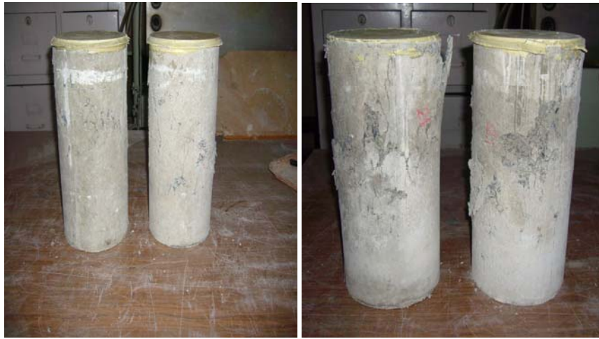
Şekil 2.12. Merkezi basınç deneyine tabi tutulmuş lifli numuneler
