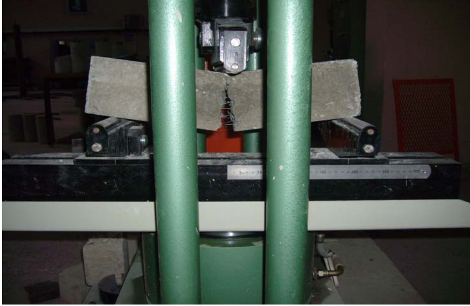
Şekil 2.34. Eğilmede çekme deneyinde lifli beton numunesinin kırılma şekli
