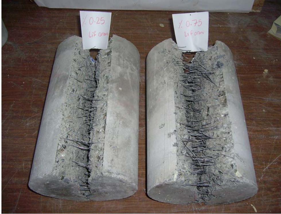
Şekil 2.26. Yarmada çekme deneyine tabi tutulmuş çelik lifli beton numuneler
