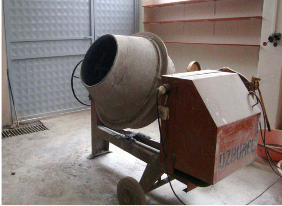
Şekil 2.4. Betonların üretiminde kullanılan 80 dm 3 kapasiteli eğik eksenli betoniyer
