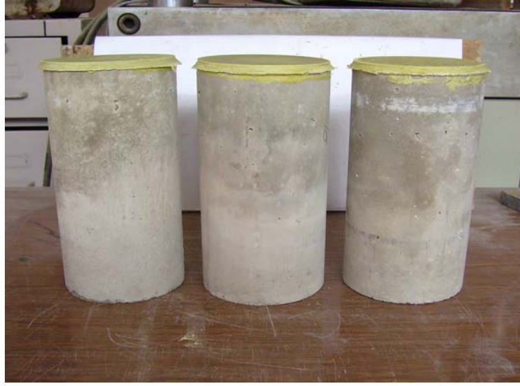
Şekil 2.10. Merkezi basınç deneyine hazırlanan beton numuneler
