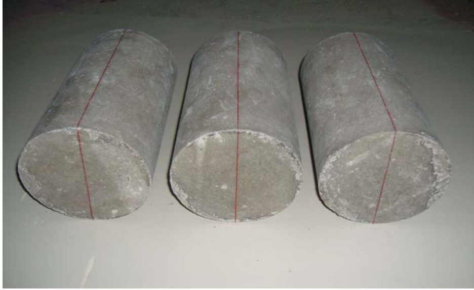
Şekil 2.17. Yarmada çekme deneyine hazırlanan beton numuneler.
