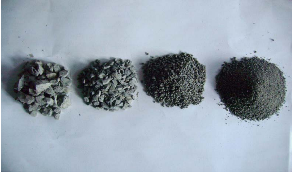
Şekil 2.1. Beton üretiminde kullanılan kalker agregalar
