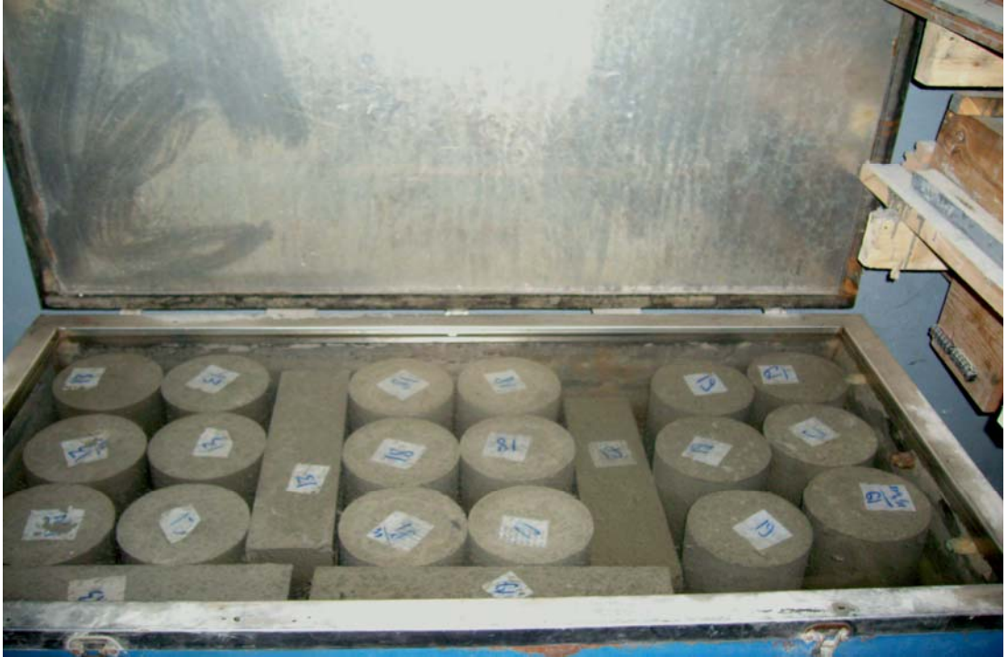
Şekil 2.7. Beton numunelerine standart kür uygulamasının yapıldığı havuzu ve tankı
