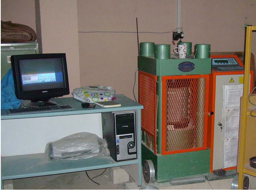
Şekil 2.9. Beton numunelerinin basınç deneyi makinesi
