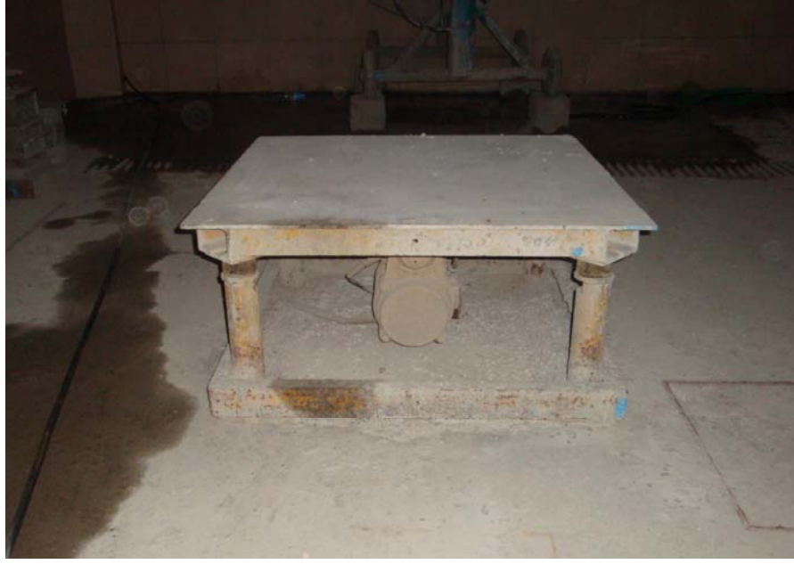
Şekil 2.5. Deneyde kullanılan 2.800 devir/dakika frekanslı sarsma tablası
