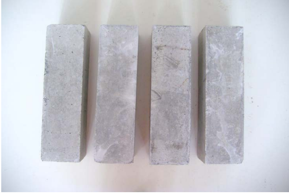
Şekil 2.27. Eğilmede çekme deneyine hazırlanan beton numuneler
