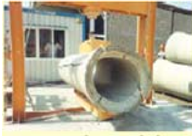
Şekil 1.13. Çelik liflerin ön yapım beton elemanlarda kullanımı
