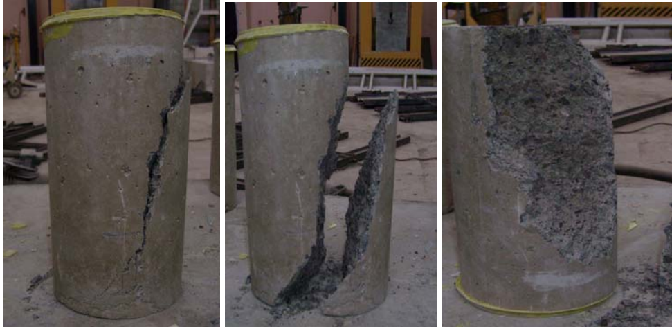
Şekil 2.11. Merkezi basınç deneyine tabi tutulmuş lifsiz beton numuneler
