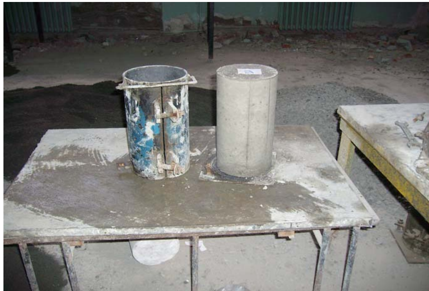
Şekil 2.6. Beton numunelerin kalıptan çıkarılması
