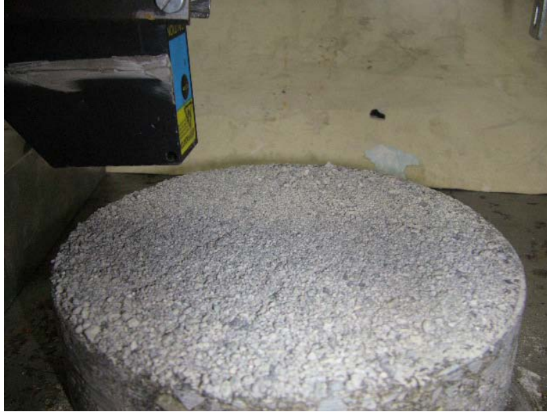
Şekil 2.7. Yüzeyine yol yüzeyinden alınan toz numune serilmiş asfalt numunenin lazer aleti ile pürüzlülüğünün ölçülmesi
