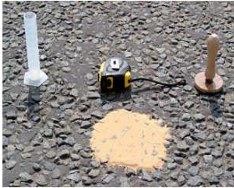
Şekil 1.8. (a) (b) Kum yama yönteminin uygulanışı [2]
