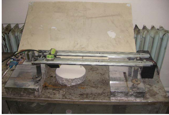
Şekil 2.5. Yüzeyine kil serilmiş numunenin lazer aleti ile Pürüzlülüğünün ölçülmesi
