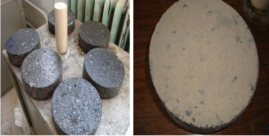
Şekil 2.4. Kum yama yönteminde kullanılan asfalt numuneler ve asfalt numune yüzeyine kumun serilmiş hali
