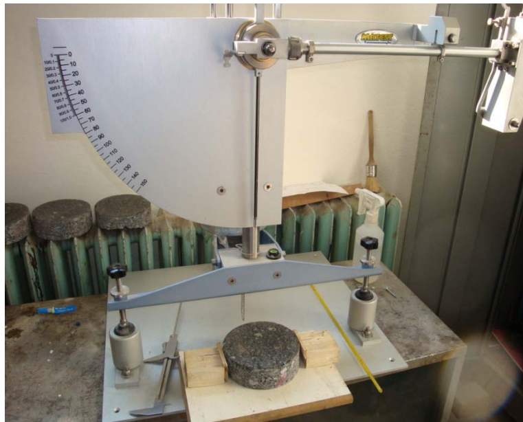
Şekil 2.13. Sürtünme katsayısı ölçüm deney düzeneği
