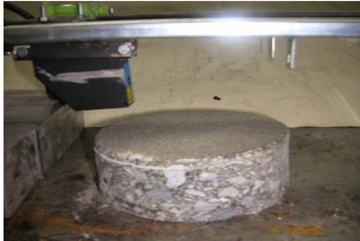
Şekil 2.6. Yüzeyine kum serilmiş asfalt numunenin lazer aleti ile pürüzlülüğünün ölçülmesi
