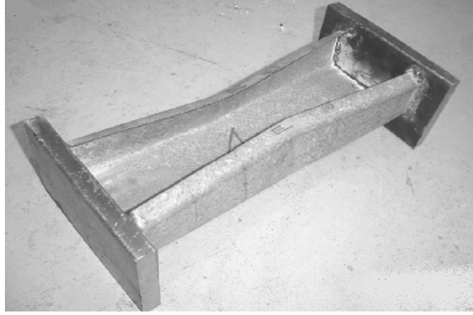
Şekil 43. Yerel burkulma etkisinde kalan kısa “C” profili [25]
