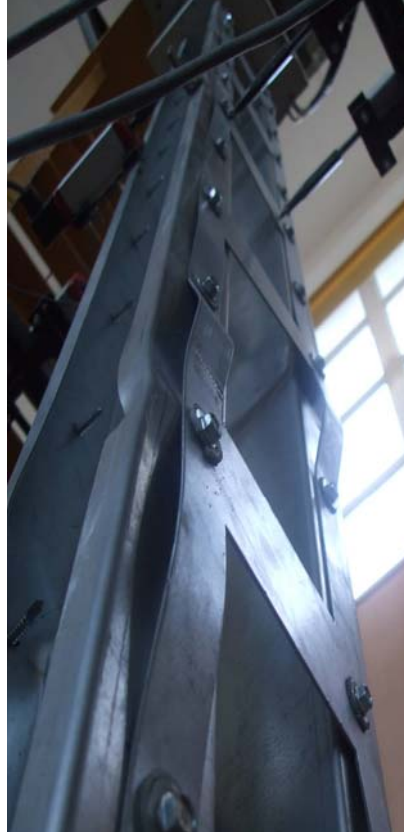
Şekil 82. Bütünleşik levhalı kolonlarda levha düşey şeridinde burkulmalar
