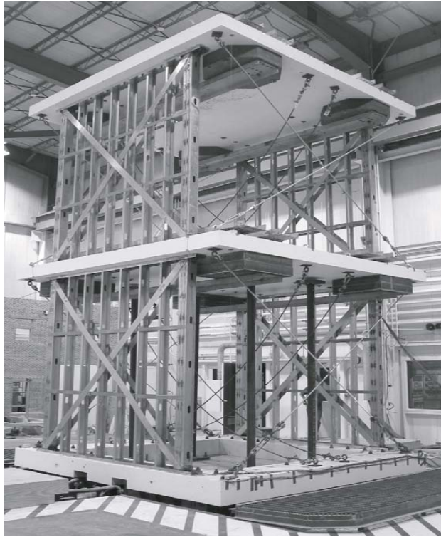
Şekil 44. Soğuk şekillendirilmiş profillerden oluşturulan panel [26]
