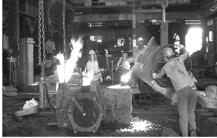
Şekil 1. Kalıplara dökülmekte olan çelik katı eriği
