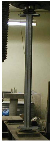
Şekil 39. Hafif çelik elemanlardan oluşan çok parçalı I kesit [21]
