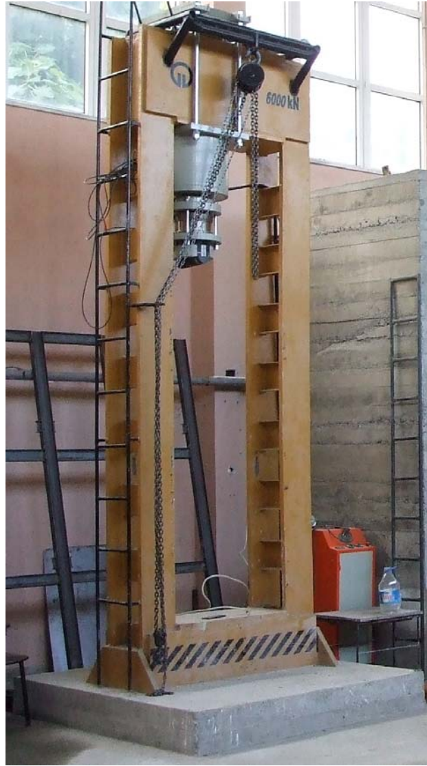
Şekil 66. Yükleme sistemi (6000 kN kapasiteli)
