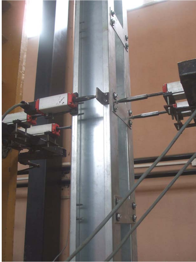
Şekil 71. LPDT'lerin deney kolonuna yerleşimi
