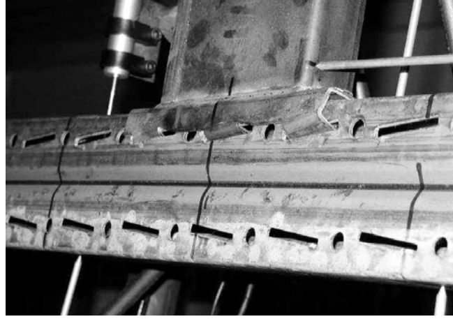
Şekil 48. Paletli rak sisteminin birleşim bölgeleri [31]
