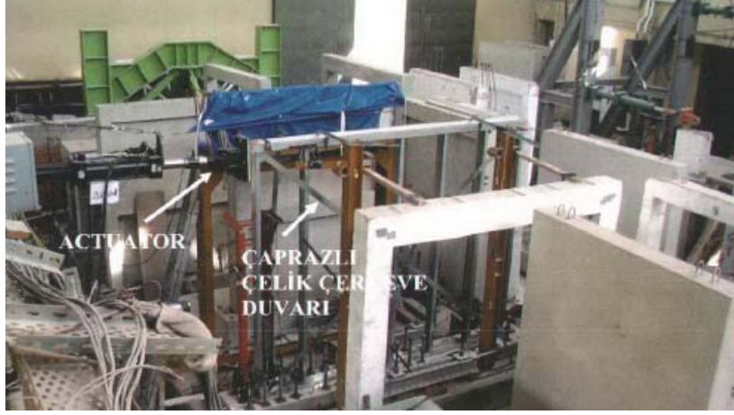
Şekil 38. Çaprazlı hafif çelik çerçeve duvarı [15]
