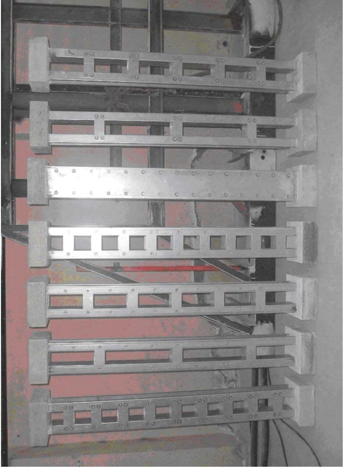
Şekil 65. Çok parçalı hafif çelik kolonların deney öncesi görünümüleri
