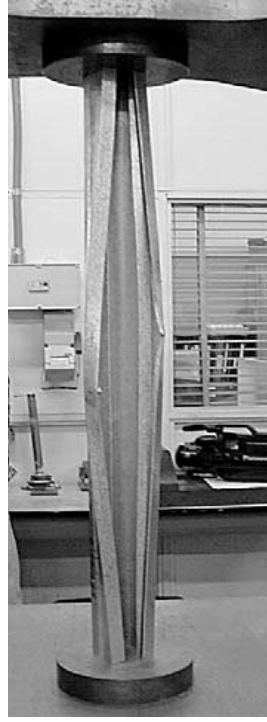
Şekil 45. Profillerde çarpımalı burkulma davranışı [28]
