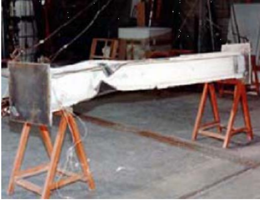
Şekil 31. Hafif çelik profilde yangın etkisi
