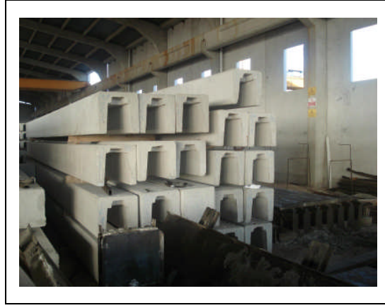
Şekil 10. Prefabrike oluk kirişi [11]
