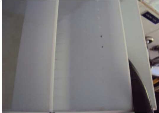
Şekil 62. Besleme kanalından verilen suyun orifislerden içeri girişi
