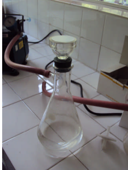
Şekil 68. Askıdaki katı madde miktarının tayini için süzgeç kağıdı kullanımı
