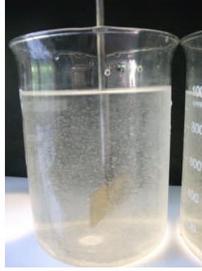
Şekil 58. Floklaşma olan numune örneği
