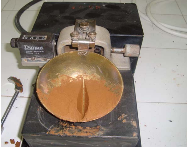
Şekil 2.2. Casangrande aleti ile likit limit değerinin belirlenmesi
