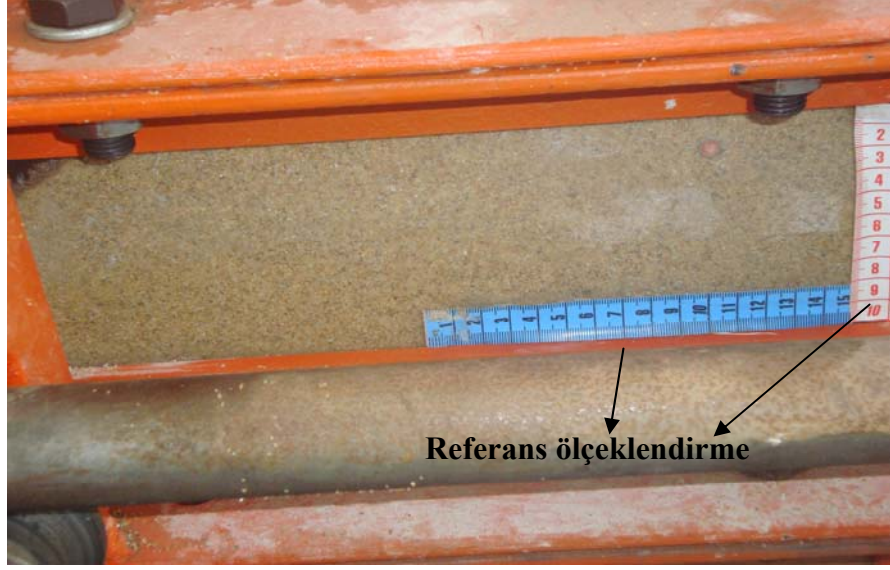
Şekil 2.8. Kenarlardaki deplasmanların ölçülmesi
