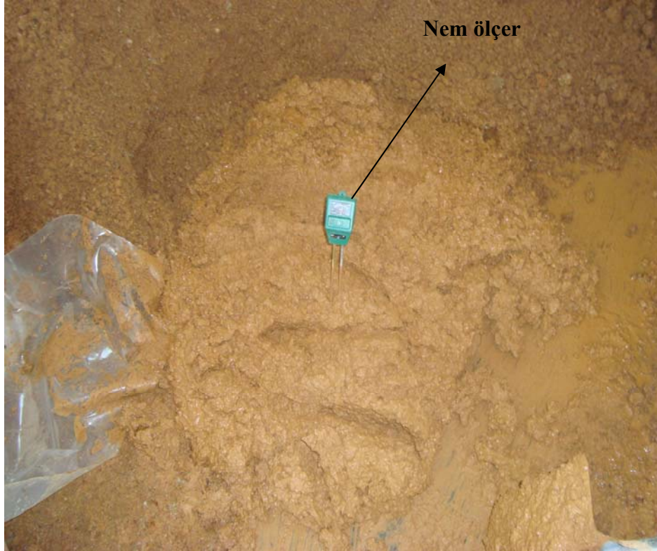
Şekil 2.6. Test kutusunun dışında hazırlanan yüksek su muhtevalı (% 45) zemin
