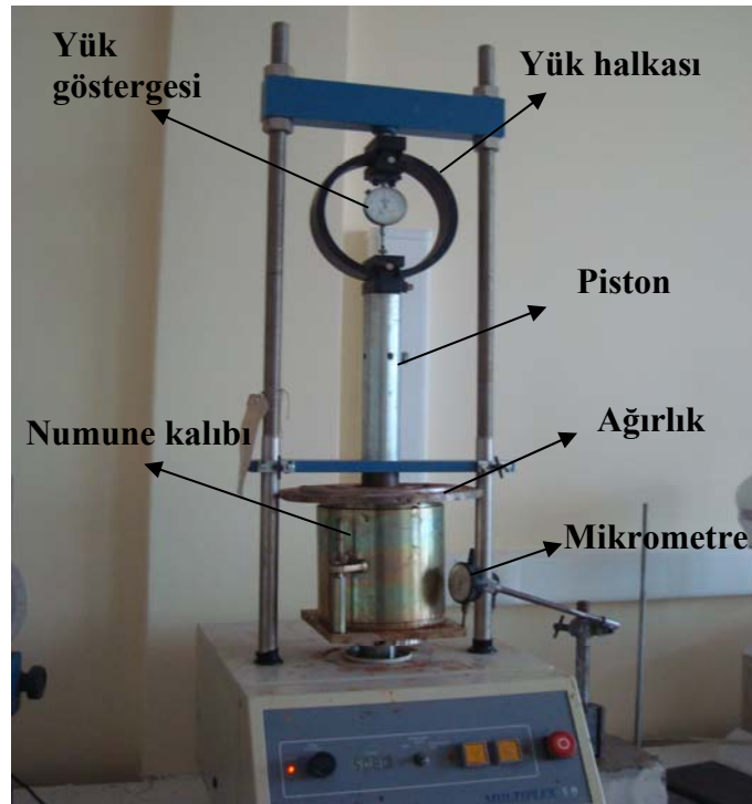
Şekil 2.4. CBR deney aleti
