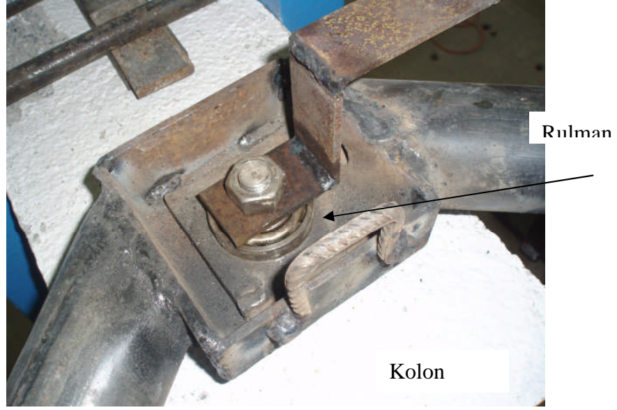
Şekil 2.19. Numune ile ankastre mesnet birleşimi ve rulman
