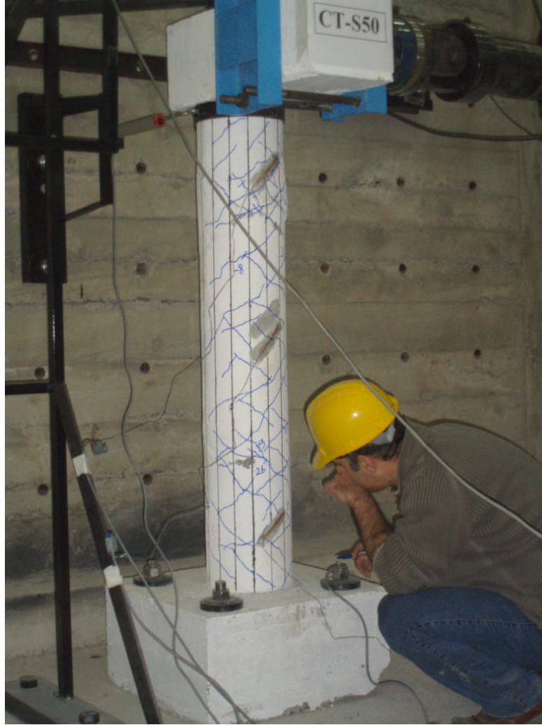
Şekil 2.30. Deney boyunca oluşan çatlakların işaretlenmesi
