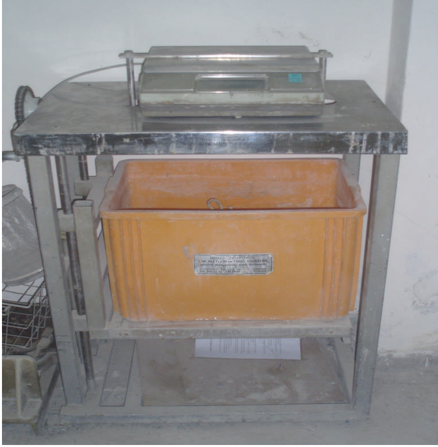
Şekil 2.2. Mettler marka PM 30 tipi tartı aleti
