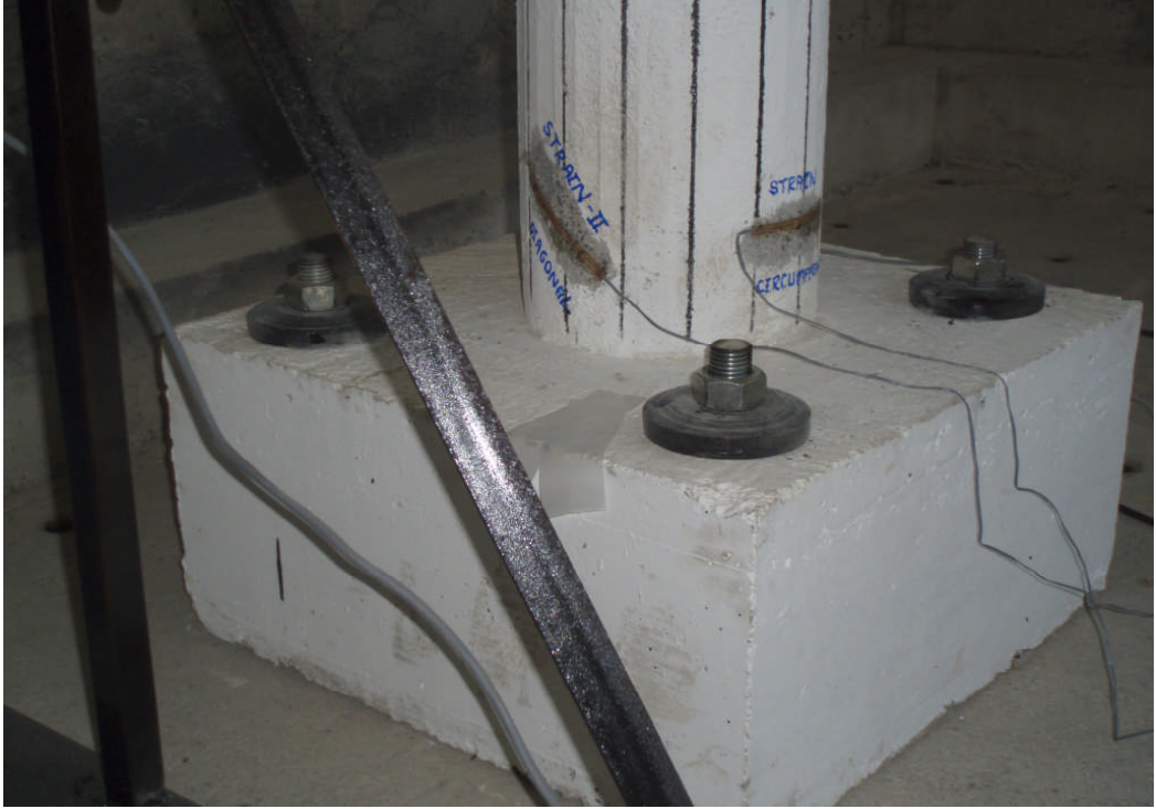
Şekil 2.25. Numune üzerindeki şekildeğiştirme ölçerler
