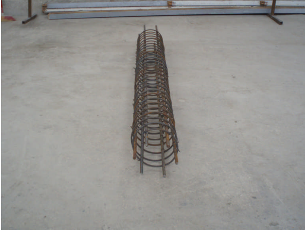
Şekil 2.11. Üretilen kolon donatısı
