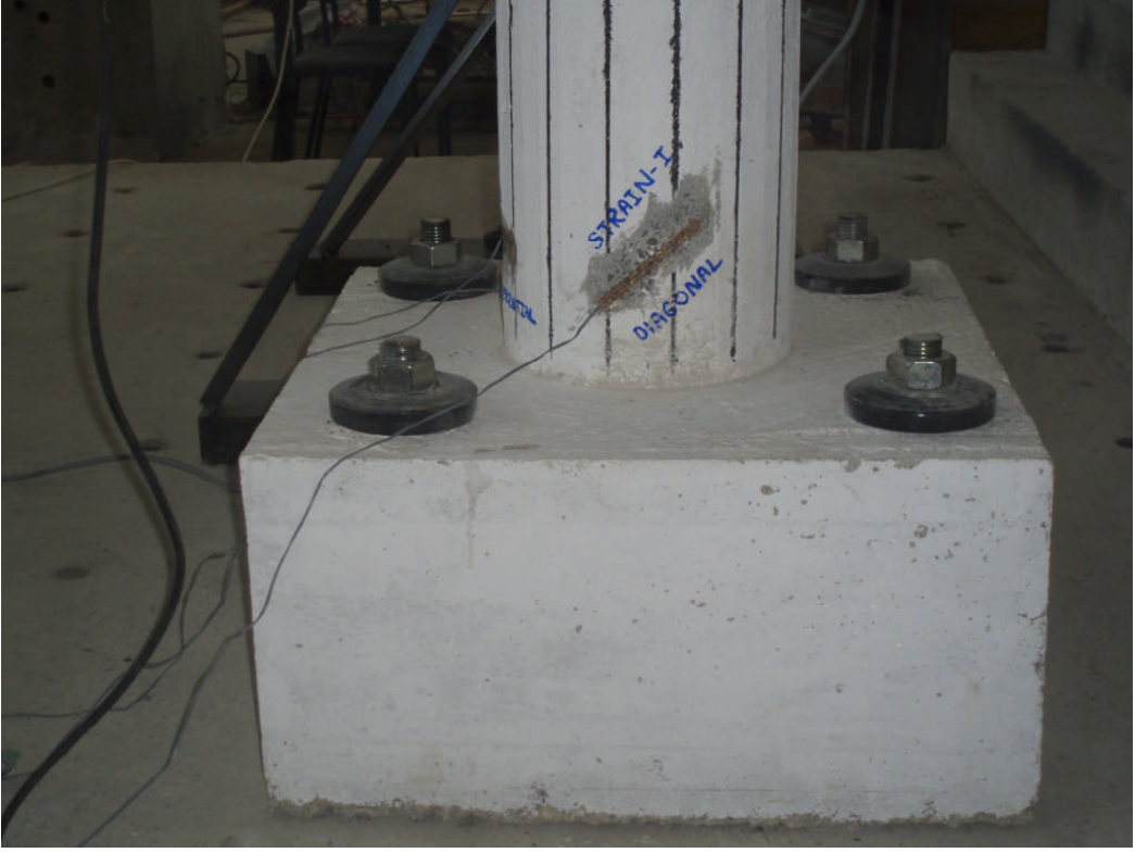
Şekil 2.17. Numune temelinin dayanma yapısına sabitlenmesi
