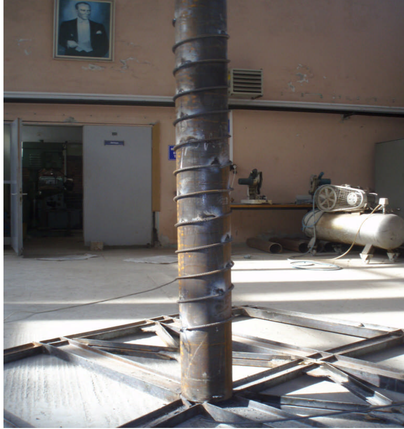
Şekil 2.7. Kolon sargı donatısı üretimi
