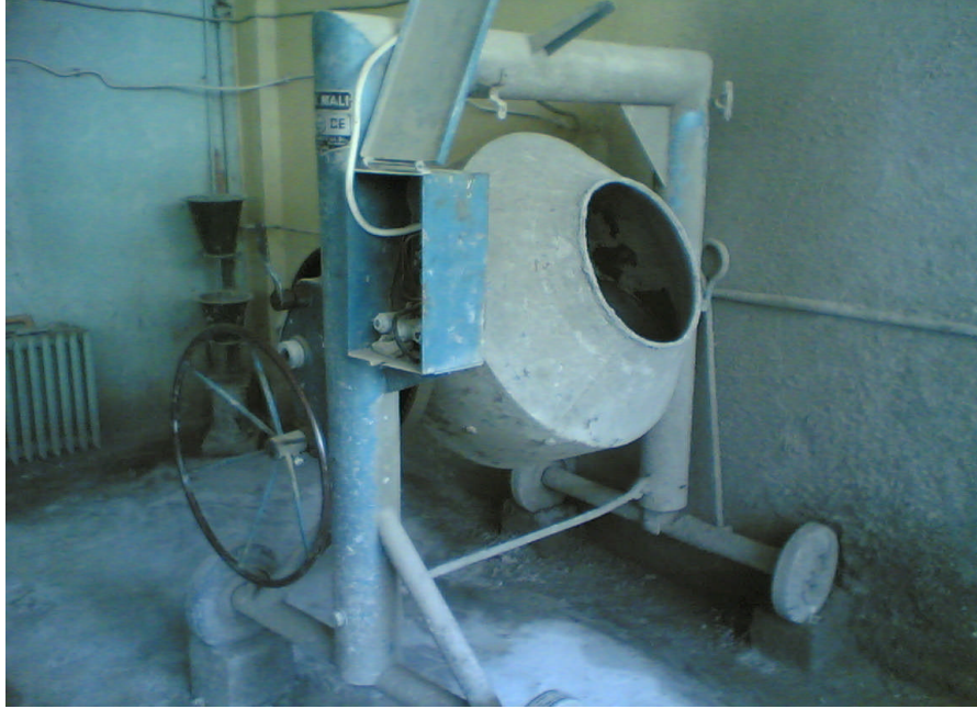
Şekil 2.3. 80 litre kapasiteli eğik eksenli betoniyer
