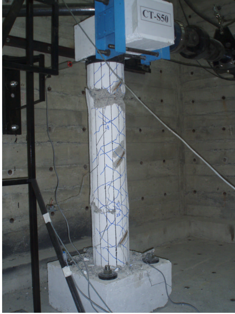
Şekil 2.31. Burulma etkisindeki fret adımı 50 mm olan kolonlarda çevrimsel yüklerden oluşan kırılma şekli
