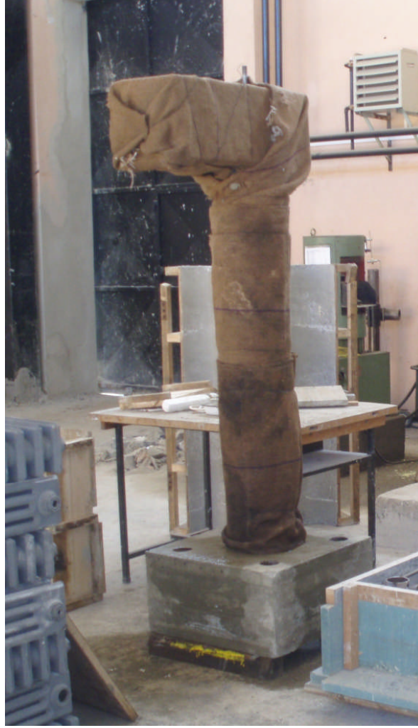
Şekil 2.15. Deney numunelerinin kürü
