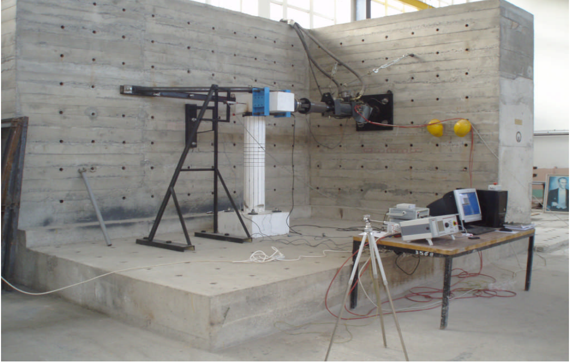
Şekil 2.28. Kolonun deneye hazırlanması ve ölçüm sistemi
