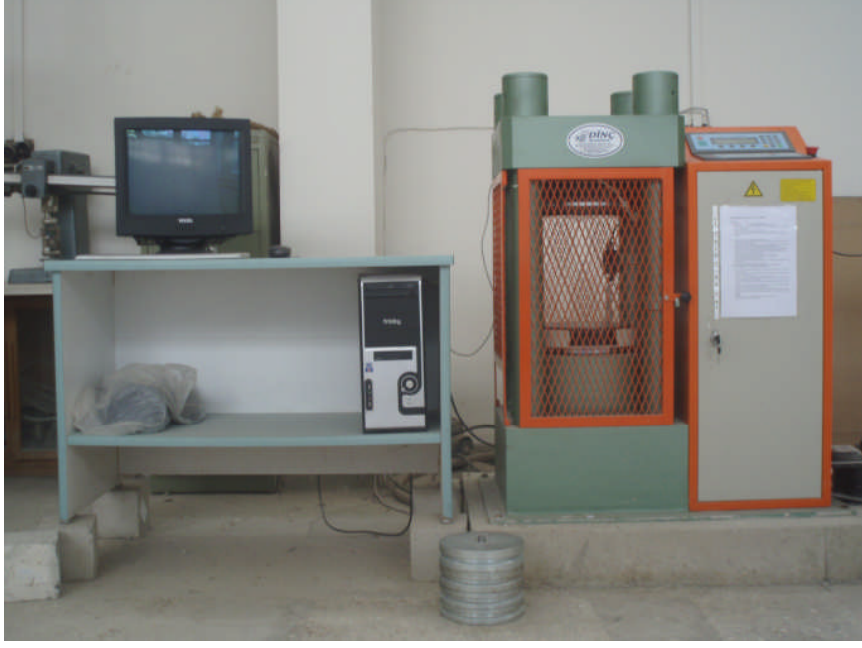
Şekil 2.4. Beton basınç dayanımı test cihazı
