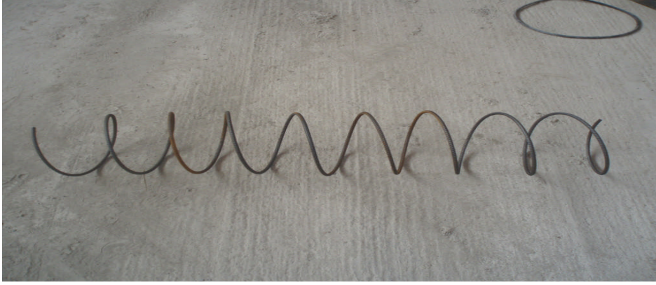
Şekil 2.8. Üretilen kolon sargı donatısı
