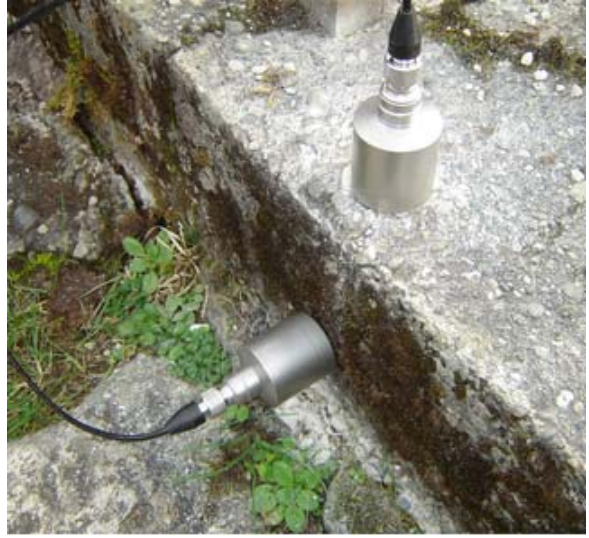
Şekil 2.5. Brüel Krajer 8340 tek eksenli ivmeölçer
