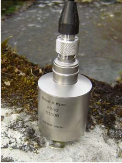
Şekil 2.5. Brüel Krajer 8340 tek eksenli ivmeölçer
