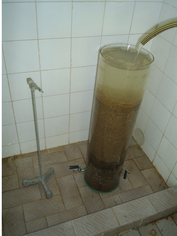
Şekil 20. Deney Setinin durutulmuş su ile beslenmesi
