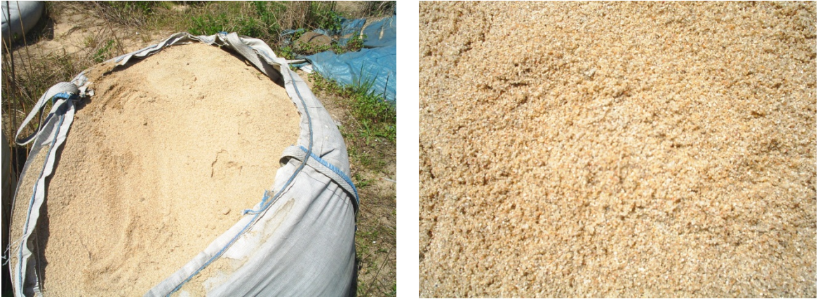
Şekil 18. Atasu arıtma tesisinde kullanılan filtre kolonunda kullanılan filtre kumu ( D = 1.18 \text{ mm} - 2.36 \text{ mm} )
