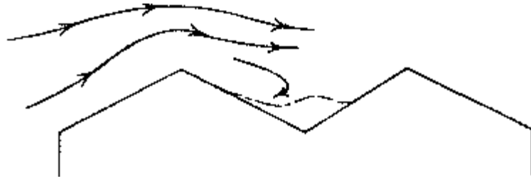
Şekil 8. Çatı derelerinde karın yığılması
