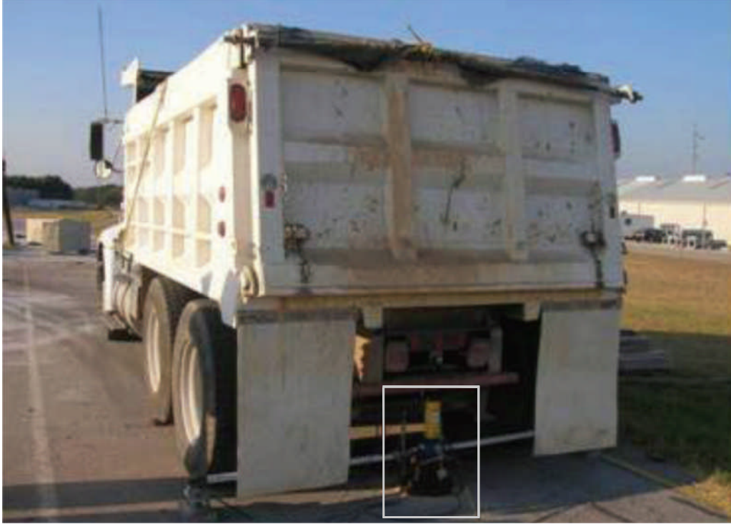
Şekil 11. Tam yüklenmiş damperli kamyonla yapılan plaka yükleme deneyi [URL-3].
