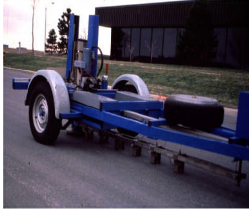
Şekil 3. FWD deney aleti [27].
