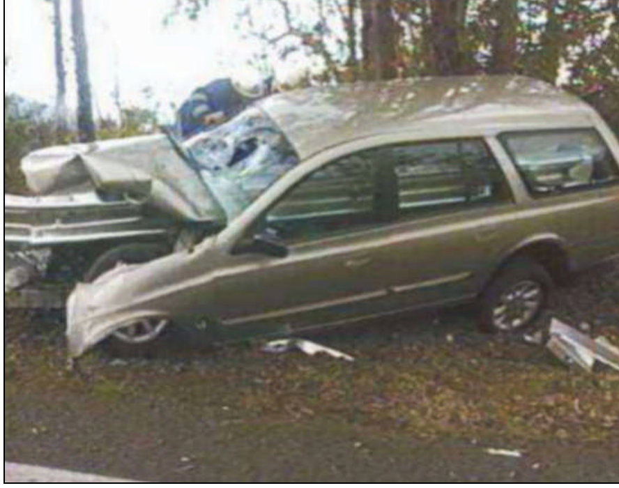
Şekil 94. Uç parçası toprağa gömülmemiş olan sisteme saplanmış araç (URL-7, 2010)
