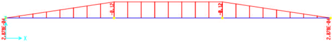
Şekil 38. 4,00 metre dikme aralıklı otokorkuluklara 2 metrelik yayılı yük yüklendiği durumdaki oluşan moment değerleri
